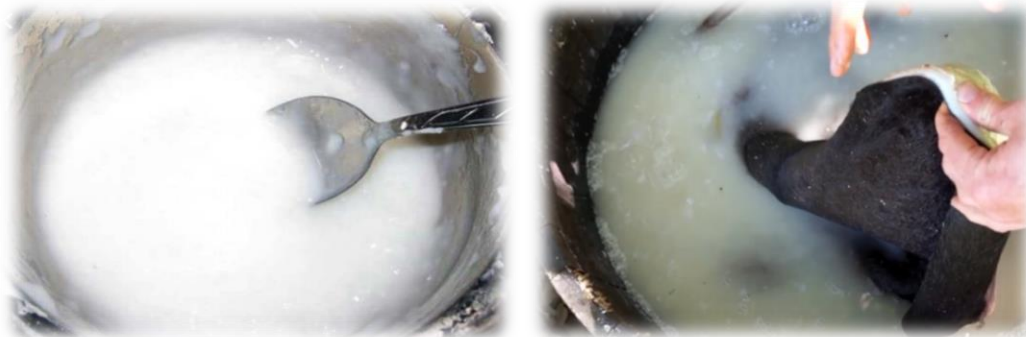
Imagen 22 y 23 –Preparación de solución de cal y piel en baño de encalado.
