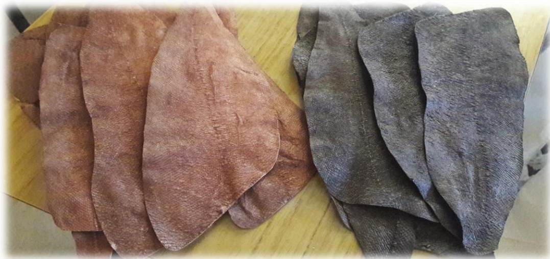
Imagen 41, 42, 43 y 44–Pielas de pescados (Pacú y boga) curtidas con taninos naturales de quebracho (algunos teñidos con agregado de anilinas).
