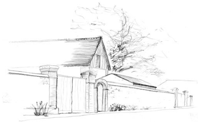
Lors de la création d'une annexe, le mur de clôture doit être conservé. L'annexe s'implante juste derrière.
