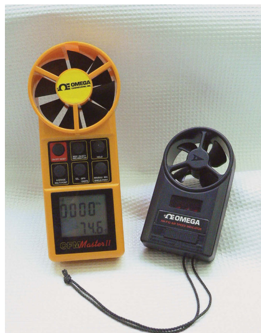
Anemómetro de astas usado para medir la velocidad del aire en movimiento
