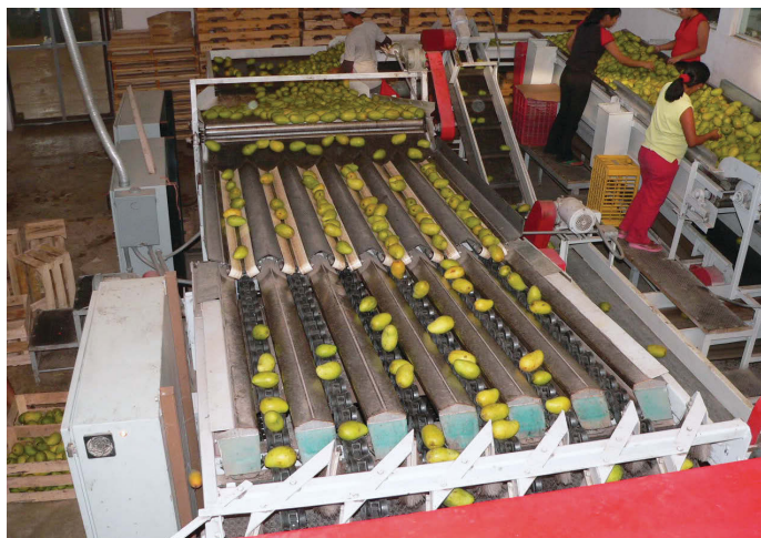
Clasificación automática por tamaño de fruto de mango en la línea de empaque
