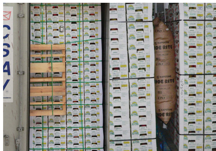
Uso de soportes de madera y bolsas de aire para estabilizar la carga en contenedores marítimos y trailers (furgones)
