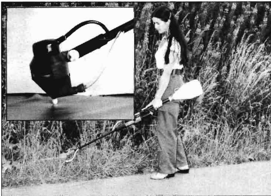
Cabezal de pulverización centrífuga para tratamiento de herbicidas en bandas, con ultrabajo volumen.
