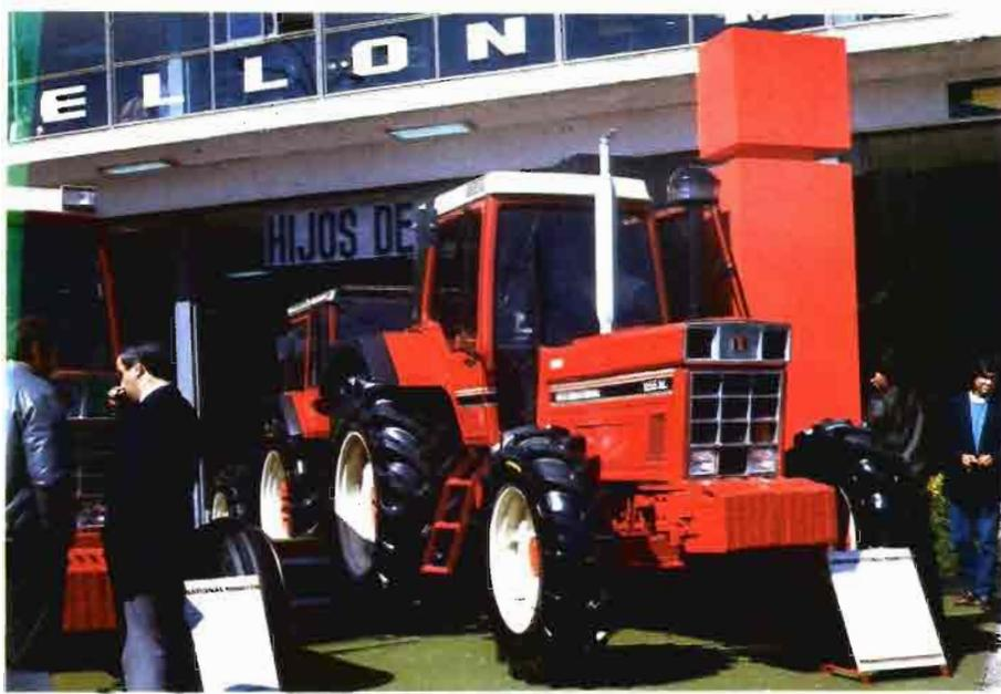
stand tres unidades más del modelo 956, uno de simple tracción, otro, el 956-A de doble tracción, y otro más de doble tracción, el 956-A-XL, dotado de la cabina de seguridad XL montada de origen, los tres incorporando un motor diesel de 104 CV a 2.200 r.p.m.
