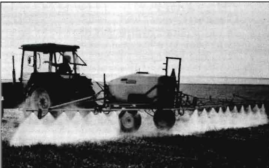
Pulverizador hidráulico, base de la aplicación de herbicidas.
