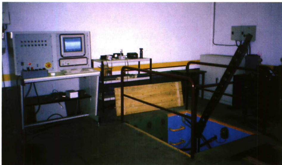
Banco de ensayo para el sistema hidráulico de tractores (EMA, Madrid).
