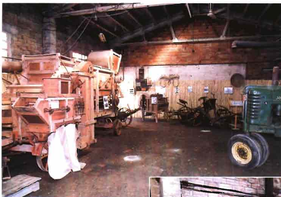
La trilladora Ajuria, que funcionaba con motor estacionario y después con tractor, y era arrastrada por caballerías, es una de las máquinas más espectaculares.
