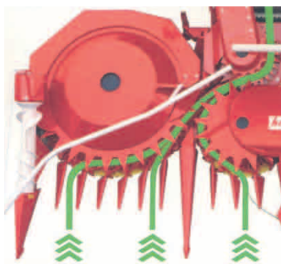
Cabezal para la siega de tallos gruesos (rotativo multidireccional)
