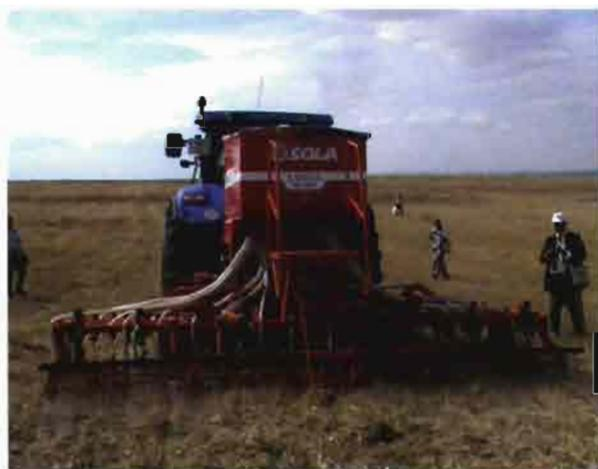
Sembradora neumática suspendida Solá SM-1909.
