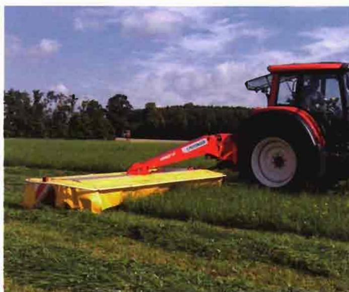
tan con un indicador de presión claramente visible en el marco de la segadora y la presión sobre el suelo puede ser ajustada mediante una válvula de control remoto de doble efecto.
