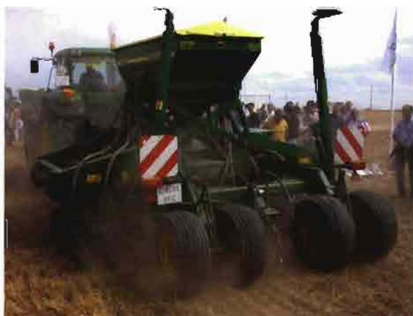
Sembradora neumática John Deere 750 A.
