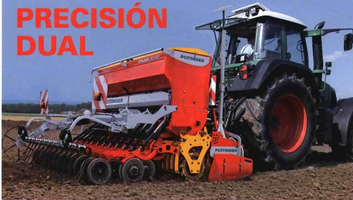
La sembradora mecánica Vitasem, una máquina con larga tradición en el catálogo de producto de Pöttinger, se renueva. Son muchas las innovaciones tecnológicas introducidas por el fabricante austriaco, entre las que destaca el sistema Dual-Disc para un depósito aún más preciso de la semilla sobre el terreno.
