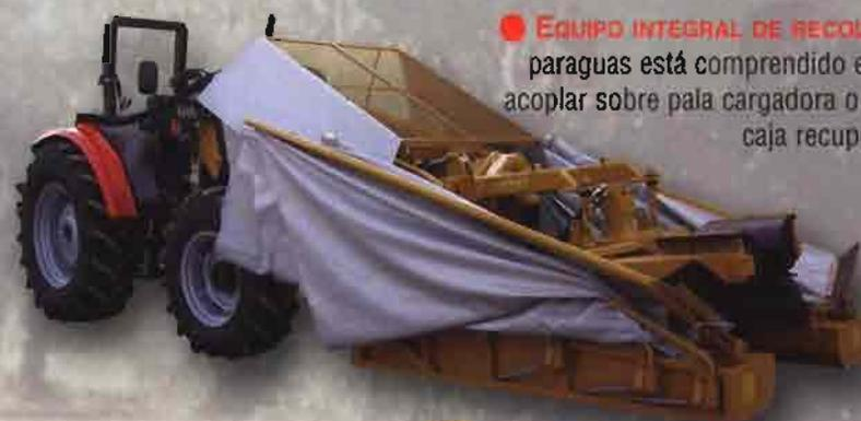
● **EQUIPO INTEGRAL DE RECOLECCIÓN** El diámetro del paraguas está comprendido entre 5 y 8 m y se puede acoplar sobre pala cargadora o en chasis recto con una caja recuperadora de unos 300 kg.
