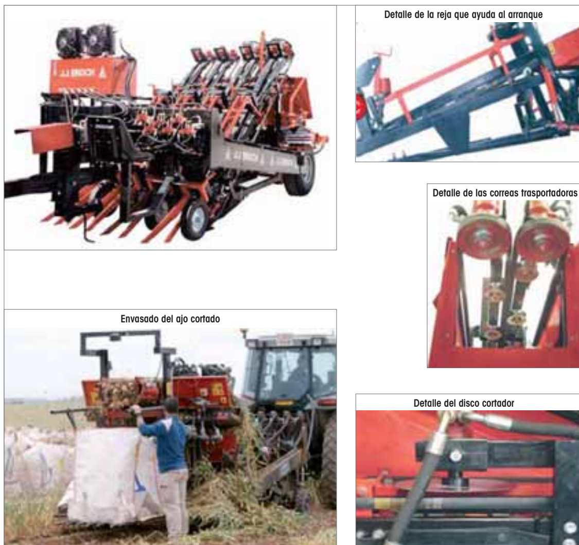
FIGURA 5.- COSECHADORA DE AJOS DE CUATRO HILERAS CON SISTEMA DE CORTE DE LAS CABEZAS
