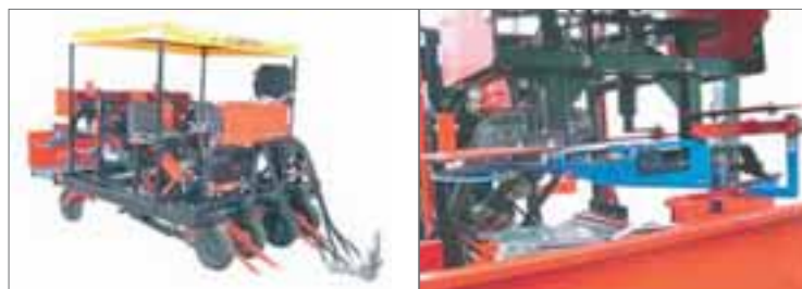
FIGURA 4.- COSECHADORA DE AJOS CON DISPOSITIVO ATADOR DE MANOJOS
