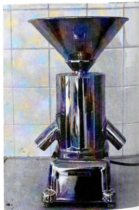
La muestra de análisis debe ser representativa. En la foto, divisor automático de muestras.
