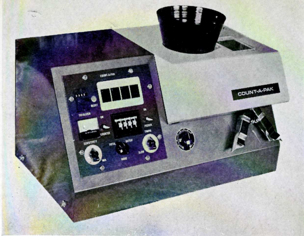
El ensayo de germinación debe hacerse, en general, sobre 400 semillas, divididas en cuatro grupos de 100 semillas. El aparato ilustrado es un contador automático de semillas.
