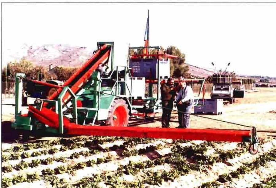
Foto 1. Máquina autopropulsada dotada con un brazo transversal, donde los operarios depositan las hortalizas cogidas a mano, y de un sistema cargador de palets.
