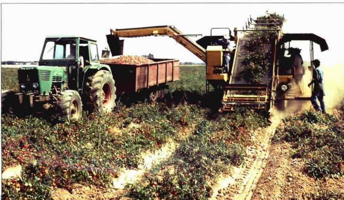
Foto 8. Cosechadora de tomate para industria con un remolque circulando en paralelo.
