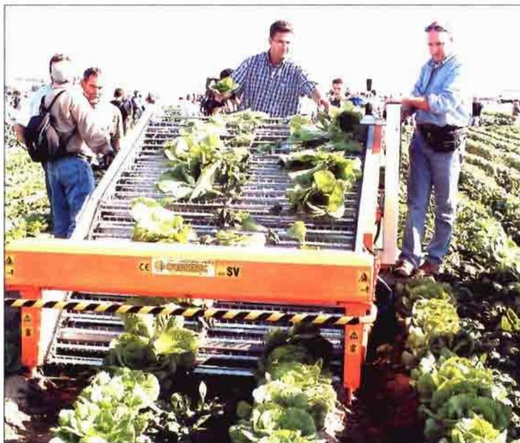
Foto 2. Cosechadora de lechugas donde el operario sólo necesita seleccionar las plantas y ayudar a cargarlas en cajas.
