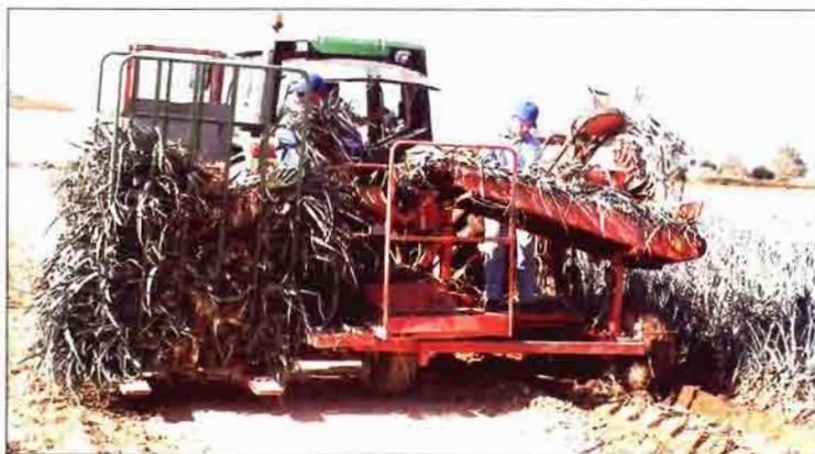
Foto 4. Vista posterior de una cosechadora de puerros, con asistencia manual para su colocación y carga en un contenedor.
