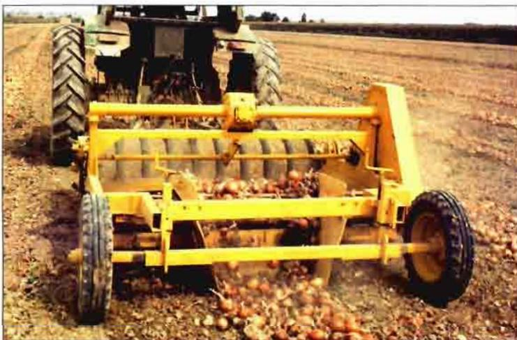
Foto 5. Vista posterior de una arrancadora-hileradora de cebollas.
