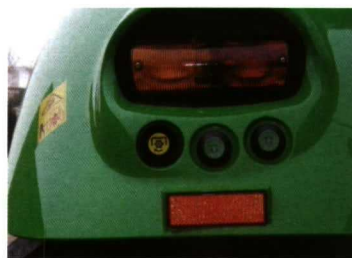
Foto 5. Pulsadores en guardabarros trasero para control de la toma de fuerza y el elevador.
