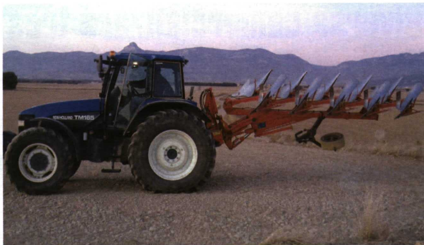
Foto 9. Tractor equipado con arado de vertedera.
