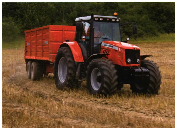
Foto 2. Cada vez más tractores incorporan transmisiones de variación continua que permiten un cambio de marchas continuo.
