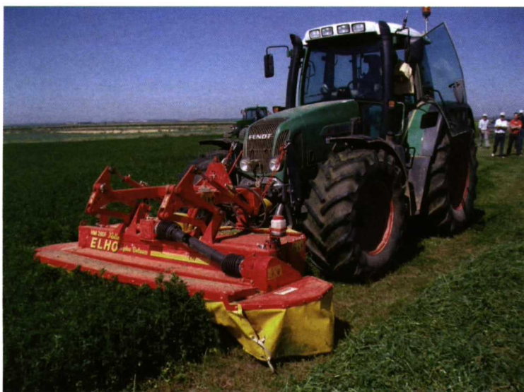
Foto 3. Tractor equipado con enganche frontal de toma de fuerza.
