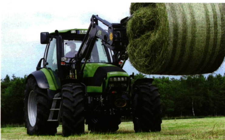
Foto 6. Es importante informarse adecuadamente de la capacidad de elevación del tractor y en qué condiciones se produce dicha capacidad.
