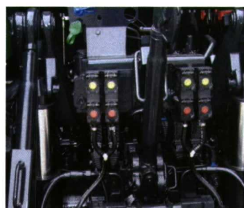
Foto 4. Salidas externas del sistema hidráulico diferenciadas mediante colores.
