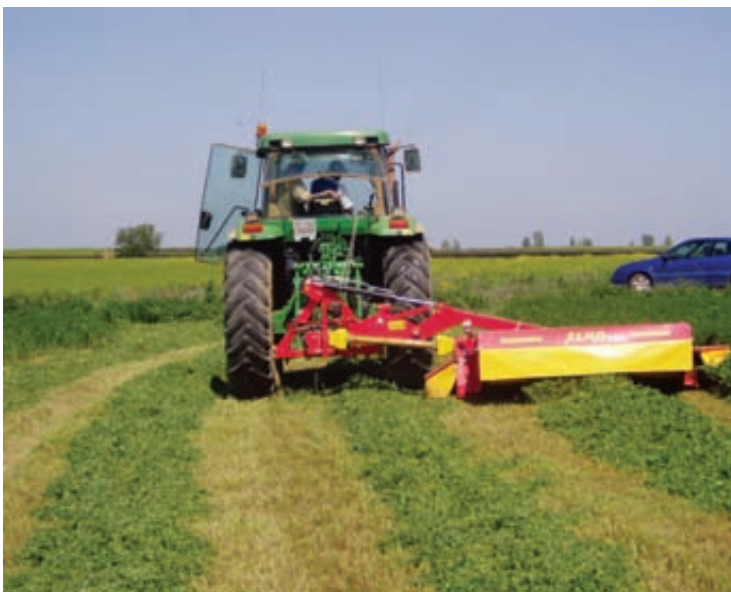
Fotos 1 y 2. Segadora rotativa de discos trabajando sobre alfalfa.
