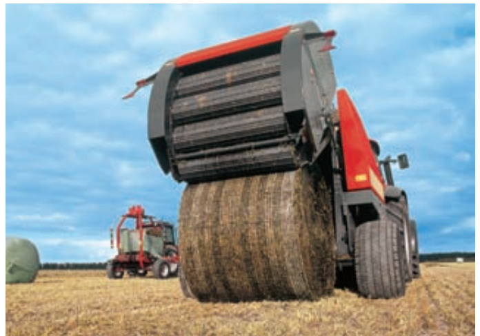
Foto 9. Rotoempacadora de cámara fija.
