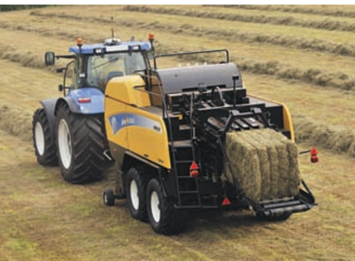
Fotos 11 y 12. Macroempacadora o empacadora de grandes pacas prismáticas.
