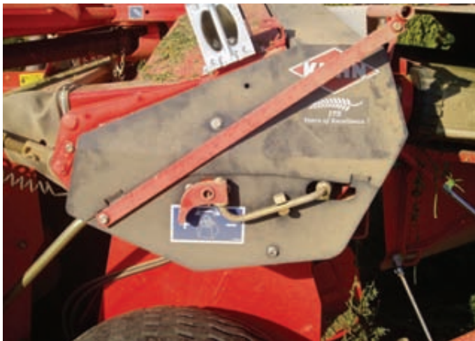
Foto 8. Sistema de regulación de la presión del cabezal de siega sobre el terreno.
