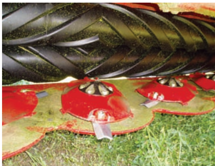
Foto 5. Segadora de discos equipada con acondicionador de rodillos de caucho acanalados.
