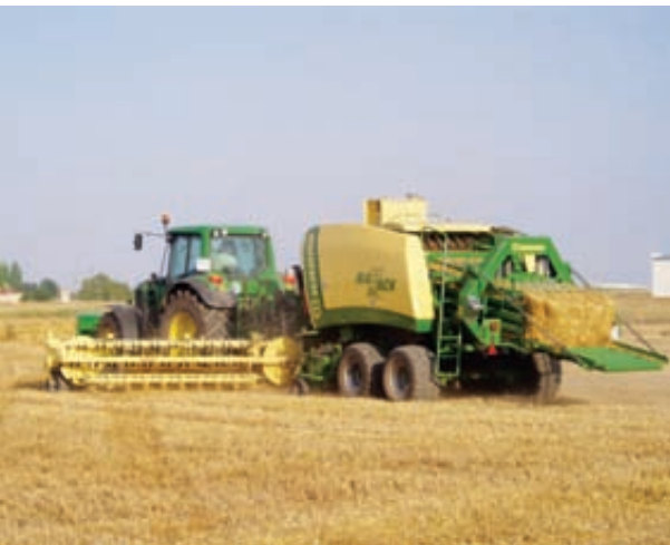
Foto 13. Macroempacadora equipada con rastrillo hilerador delantero.
