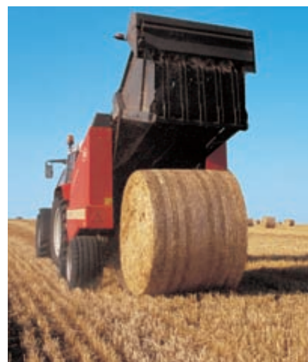
Foto 10. Rotoempacadora de cámara variable.
