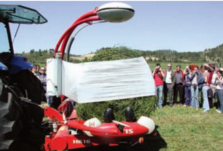
Fotos 14 y 15. Encintadora envolviendo una paca cilíndrica con film plástico.
