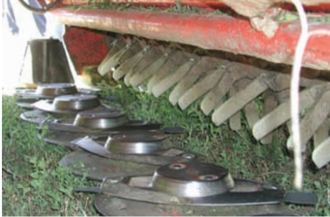
Foto 6. Segadora de discos equipada con acondicionador de dedos de plástico en V.
