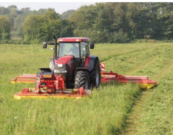
Foto 4. Se pueden conseguir grandes anchuras de trabajo combinando varias segadoras en una misma cabeza tractora.
