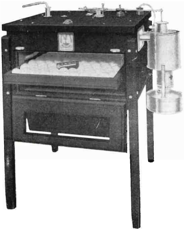
Fig. 1.—Incubadora horizontal con capacidad para 100 huevos, de calefacción mixta.
