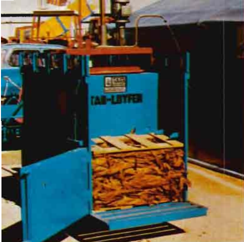
Fig. 23.—Prensa eléctrica de doble cuerpo para enfardado del tabaco.
