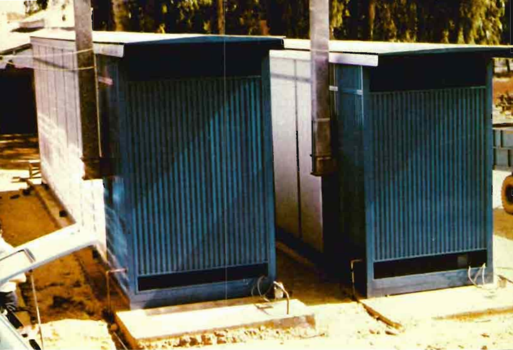
Fig. 11.—Secaderos prefabricados de funcionamiento independiente, con capacidad individual de 72 bandejas.
