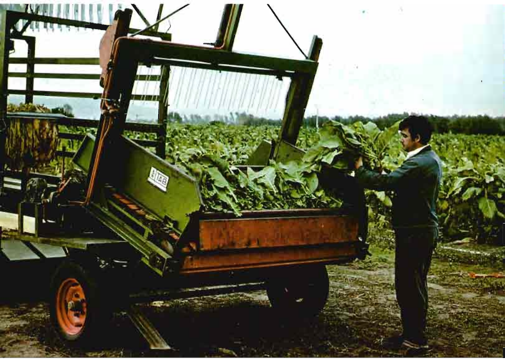
Fig. 17.—Mesa para ensartado hidroneumático de tabaco.
