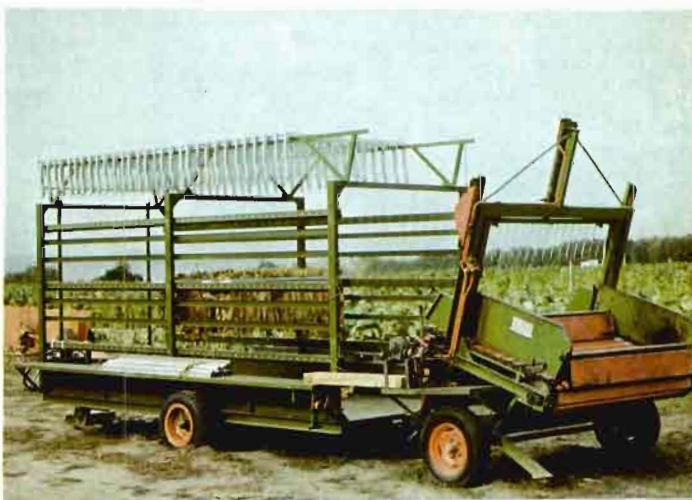
Fig. 8.—Detalle de remolque y mesa para confección de bandejas provista de sistema hidroneumático de ensartado.
