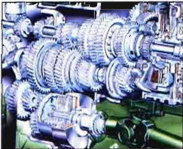
**Transmisión.-** En la serie 6010 se han incorporado dos nuevas opciones de transmisión dotadas de sistemas electrónicos. Las nuevas transmisiones PowrQuad Plus y AutoQuad se controlan mediante una palanca monomando con pulsadores para el cambio hidráulico sin embrague entre las cuatro marchas. El sistema de
