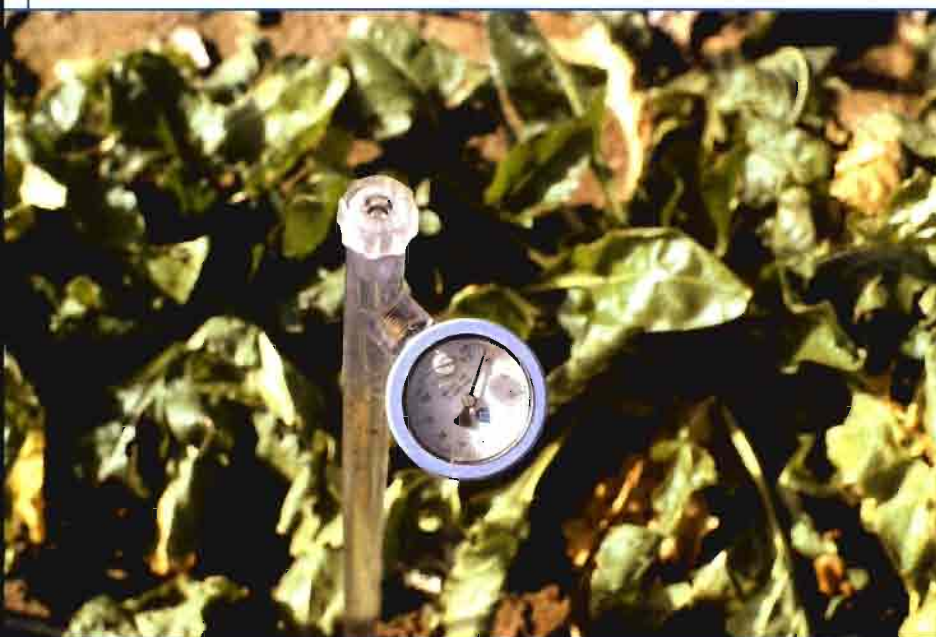
Tensiómetro colocado para controlar la humedad del suelo
