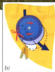
Repartidor-cortador con cuchillas circulares para impedir las obstrucciones en las salidas individuales.
