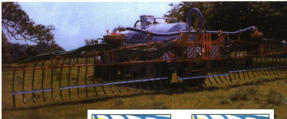
menos flexibles, con punta escarificadora o extirpadora (tipo 'cola de golondrina'), combinadas con elementos que le ayudan a profundizar a la vez que controlan la profundidad de trabajo.
