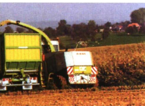
Utilizando un bastidor universal se puede cambiar la cisterna por diferentes tipos de caja así como la posición de la carga durante el transporte.
