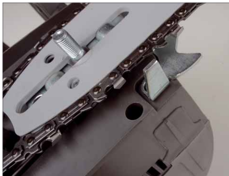
Vertrauenerweckend: der Kettenfangbolzen aus Metall sorgt bei Stiga für Sicherheit, wenn die Kette reißen sollte
