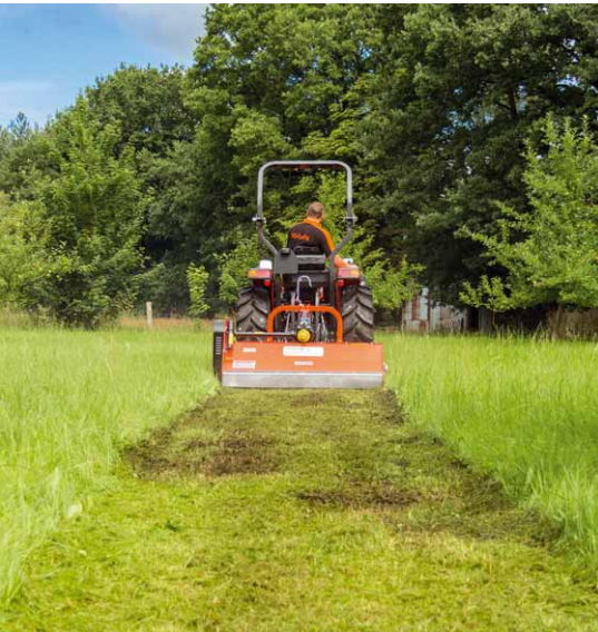
Das Kubota-Schlegelmähwerk hat eine Arbeitsbreite von 160 cm. Es kommen Y-Schlegel zum Einsatz, die für ein sauberes Ergebnis sorgen
