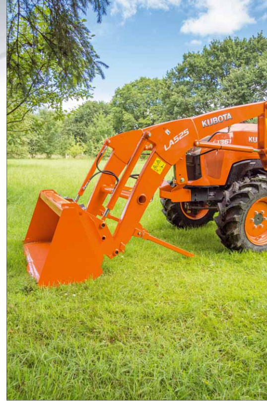
Zum Abbau des Frontladers werden zuerst auf beiden Seiten die integrierten Stützen ausgeklappt, dann wird der Frontlader auf der Schaufel und den Stützen abgesetzt
