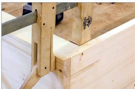
10 Um die Auflageleisten mit Holzdübeln noch stabiler zu befestigen, kann man einfach von außen mit dem 6-mm-Bohrer Dübellöcher bohren ...
