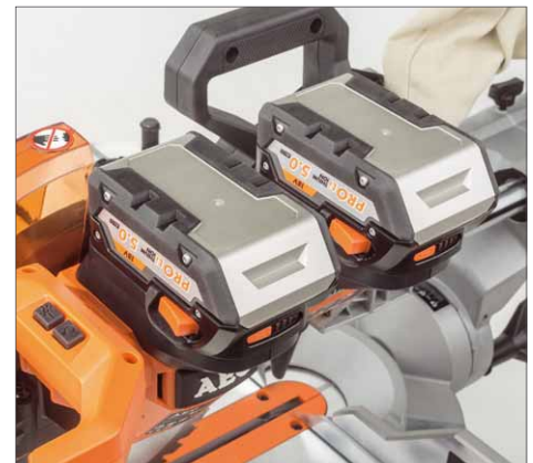
Die Akkus werden parallel betrieben, das heißt, die Betriebsspannung bleibt bei 18 Volt, aber die Stromkapazitäten der Akkus addieren sich
