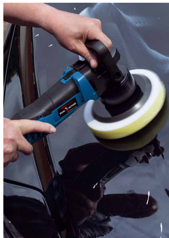
Die Schwingzahl lässt sich stufenlos zwischen 1500 und 6800 1/min regeln
