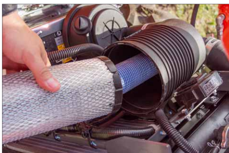
Der zweiteilige Luftfilter ist ebenfalls gut zu erreichen und lässt sich ohne Werkzeug wechseln
