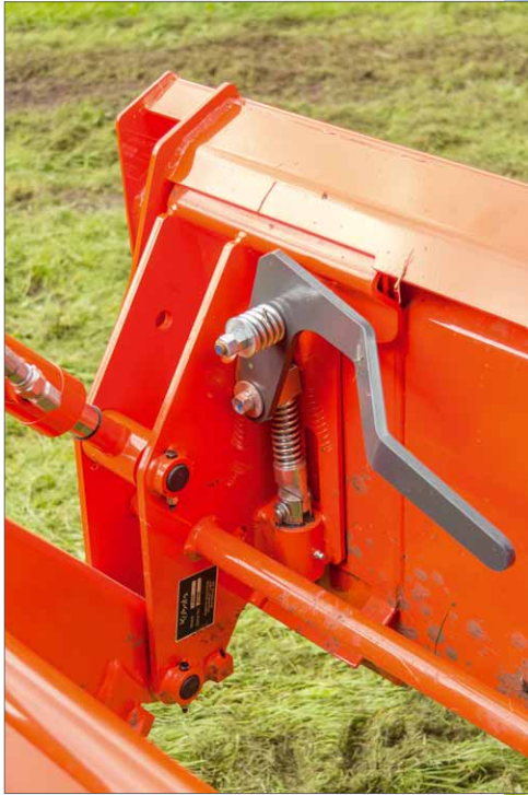
Die Schaufel des Frontladers findet an einem Euro-Adapter Aufnahme
