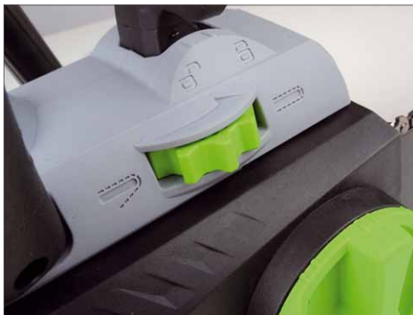
Bei EGO sitzt das Einstellrad für die Kettenspannung halb im Gehäuse versenkt
