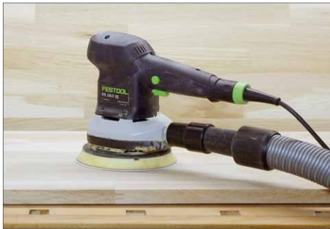
Mit feinem Schleifmittel (ab 180er) kann man auch rohes Holz mit dem Exzentrerschleider bearbeiten
