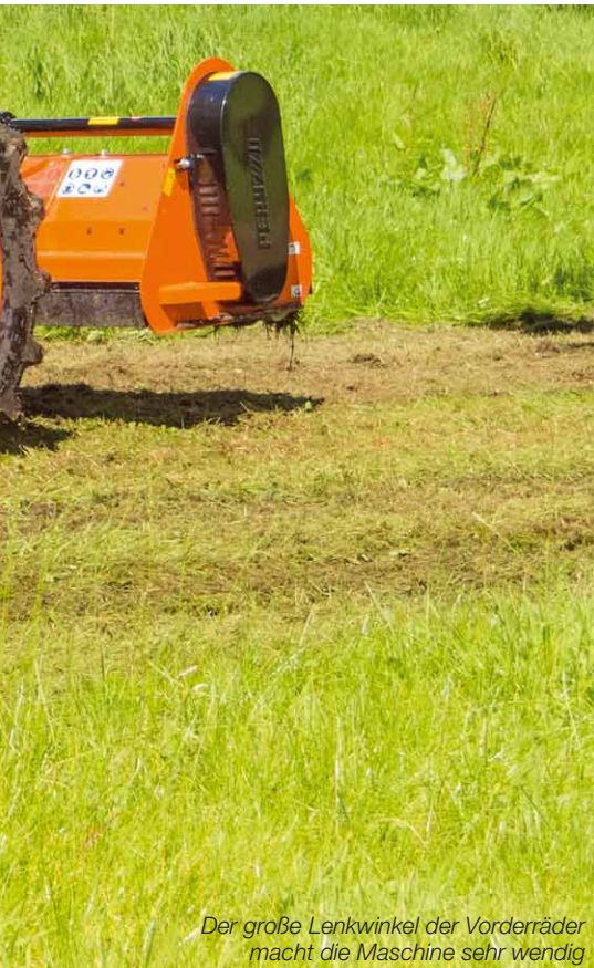
Das Kubota-Schlegelmähwerk hat eine Arbeitsbreite von 160 cm. Es kommen Y-Schlegel zum Einsatz, die für ein sauberes Ergebnis sorgen
