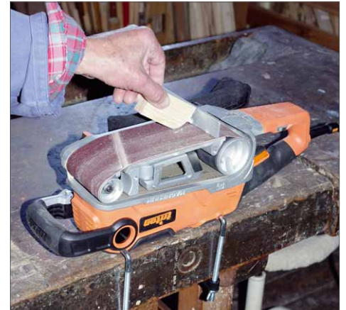
Viele Bandschleifer lassen sich mithilfe einer Tischbefestigung auch stationär einsetzen, um kleine Werkstücke bearbeiten zu können
