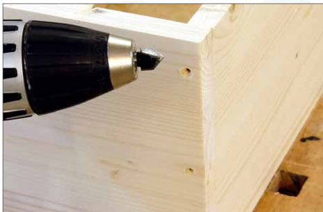
4 Damit die Schraubenköpfe das Holz an den Kanten nicht einreißen, sollte man mit einem Senkbohrer ansenken
