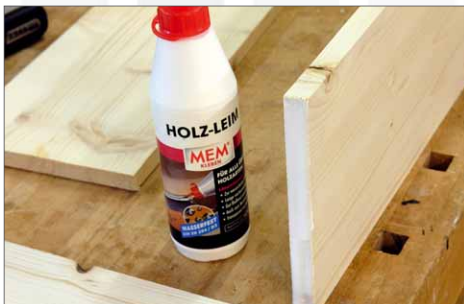
5 Dann wird Leim an beide Verbindungsflächen angegeben. Da Stirnholz schlecht leimt, nicht am Leim sparen. Die Schrauben können schon so weit eingedreht werden, dass die Spitzen herausgucken. Da die Spitzen in die vorgebohrten Löcher rutschen, findet man die exakte Position schnell wieder
