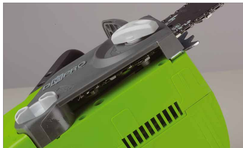
Der Spanauswurf ist bei allen Sägen groß bemessen
