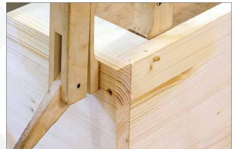
12 Der Dübel sollte ein kleines Stück überstehen
