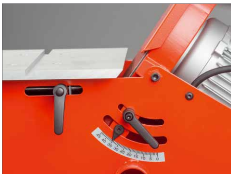
Um Winkel zu schleifen, wird die komplette Schleifeinheit nach hinten gekippt
