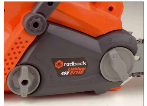
Kette spannen leicht gemacht: Zuerst wird das Schwert mit der vorderen Schraube gelockert, danach wird am hinteren Drehrad die Kettenspannung korrigiert
