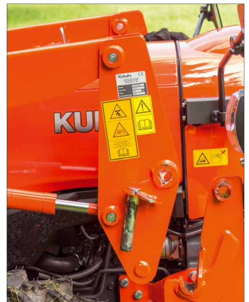
Zum Schluss wird der Lader per Hydraulik aus dem Halter gehoben. Dabei ist darauf zu achten, dass die Vorderräder unter den Halteplatten durchrollen können. Als Letztes werden die Schnellverschlüsse der Hydraulikleitungen getrennt
