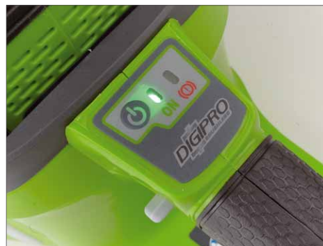
Über einen Folienschalter wird die Säge erst eingeschaltet, bevor der Gashebel funktioniert
