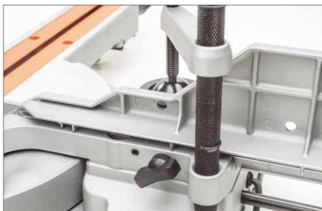
Die Anschläge auf beiden Seiten können bewegt werden. Dabei arretiert sie jeweils eine Knebelschraube; eine Madenschraube verhindert, dass die Anschläge herausgezogen werden können
