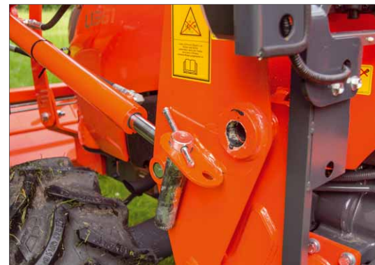
Danach werden die beiden Haltebolzen gezogen. Sie können in den seitlichen Bohrungen gelagert werden
