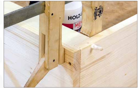
11 ... und die Dübel unter Angabe von Leim von außen eintreiben
