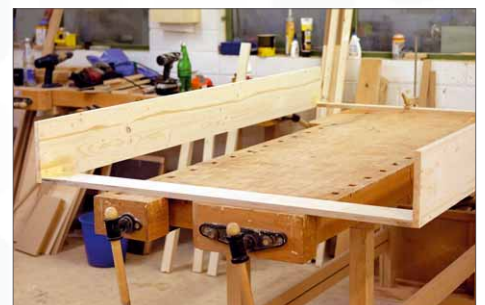
14 So werden die Seiten des oberen Rahmens zunächst mit den Auflageleisten verbunden
