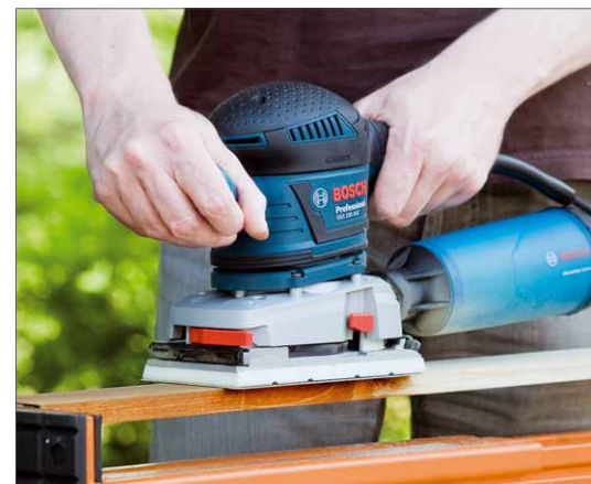
Bei unregelmäßigen Oberflächen ist Schleifvlies eine gute Alternative zu Schleifpapier
