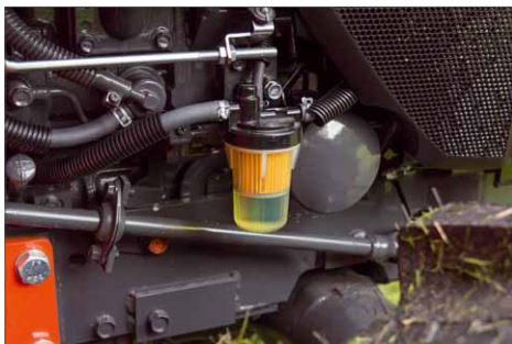
Der Kraftstofffilter sitzt gut zugänglich seitlich am Motorblock
