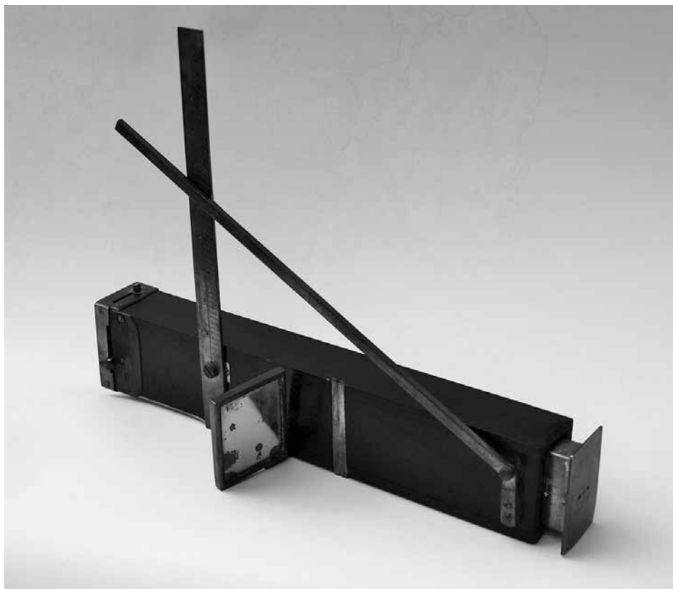
SLIKA 2. Šporerov dendrometar, sačuvan u zbirci instrumenata Šumarskoga fakulteta Sveučilišta u Zagrebu
