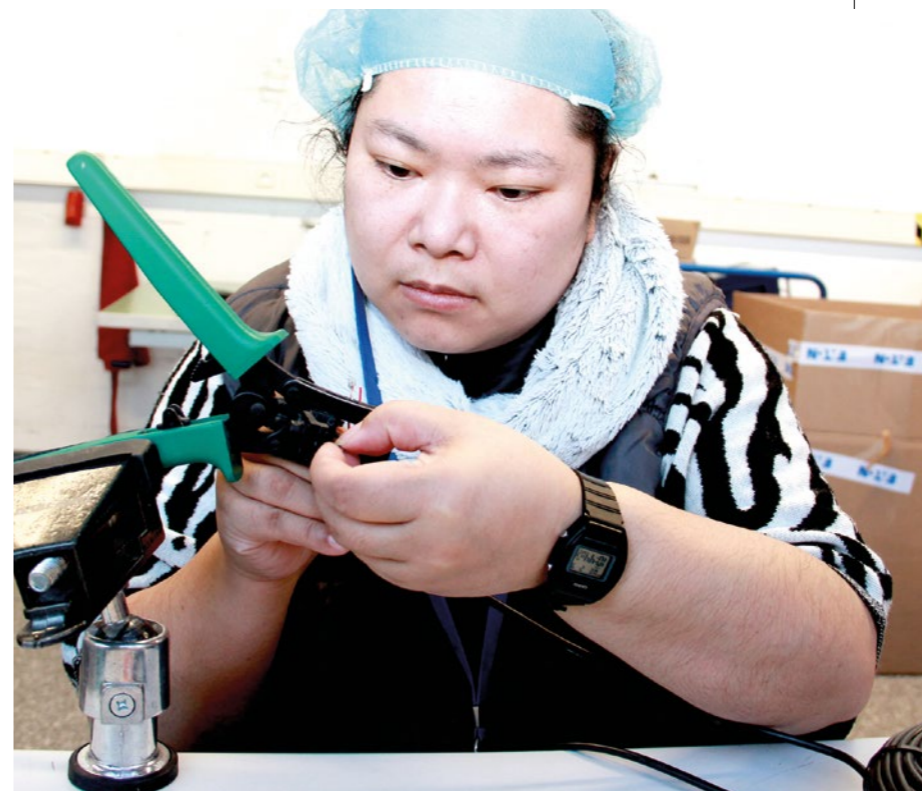
Maria Pang isoliert Kabel für die Weiterverarbeitung ab.
