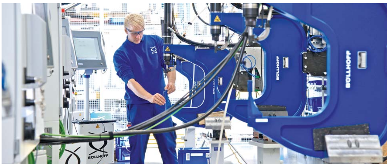
Montage von RIVSET® Stanznietensystemen zum Fügen von Blechen
