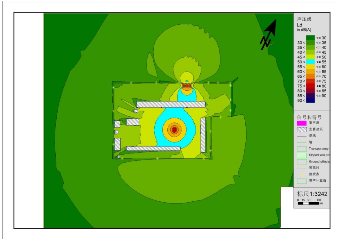
图 6-17 波密 500kV 变电站本期站界处噪声预测值等声级曲线
