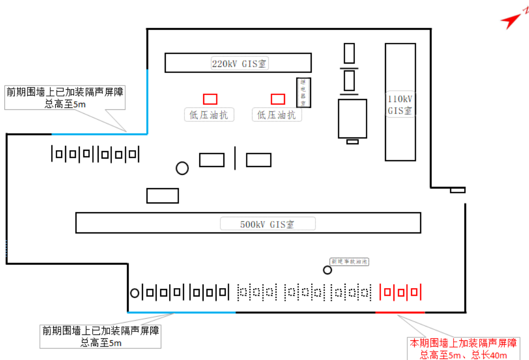
图 6-12 巴塘 500kV 变电站本期降噪措施示意图
