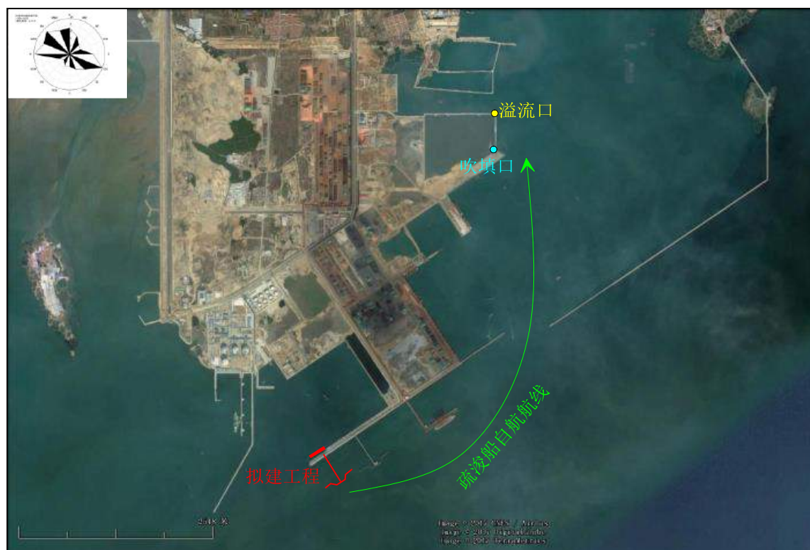
图 4.6-3 疏浚工程吹填口、溢流口及疏浚船航线图
