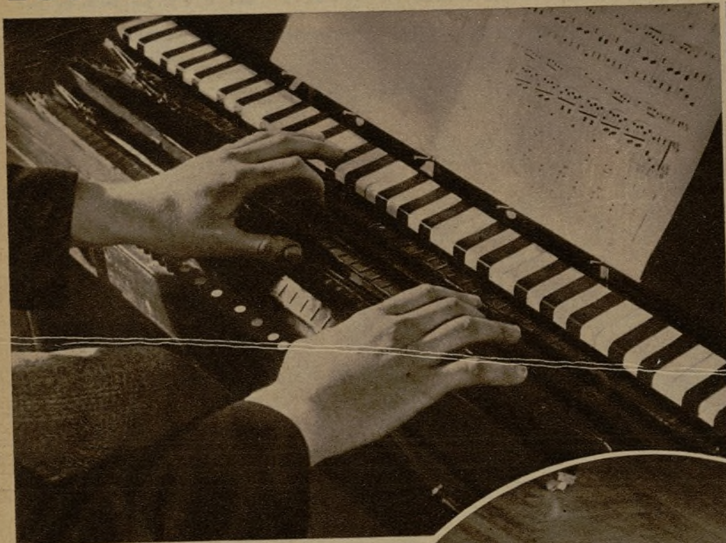
Un piano eléctrico que se llama "Heller-tion", según su inventor. Se toca con cuatro cintas de goma, sobre las que se han puesto barritas de metal. Para facilidad del operador se coloca encima un teclado marcado
