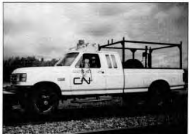
Camionnette d'inspection des voies ferrées.
