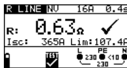
Figura 5.41: Ejemplo de los resultados de la medición de la resistencia de línea
