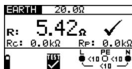
Figura 5.50: Ejemplo de resultados de la medición de la resistencia de tierra
