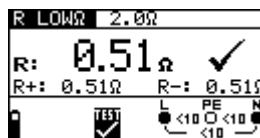
Figura 5.14: Ejemplo de la medición de la resistencia de bajo valorΩ
