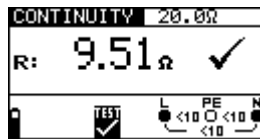
Figura 5.18: Ejemplo de un resultado de medición de la continuidad
