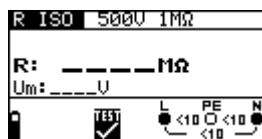
Figura 5.1: Menú de la medición de la resistencia de aislamiento.
