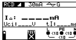
Figura 5.25: Menú de la medición de la corriente de disparo
