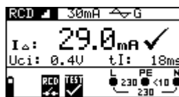
Figura 5.26: Ejemplo de los resultados de la medición de disparo de corriente
