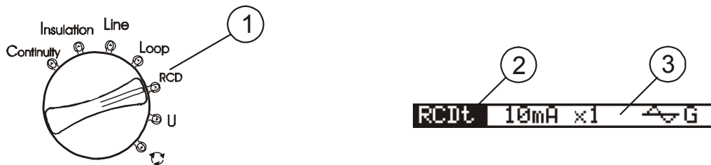
Figura 4.2: Selector de funciones y línea de parámetros
