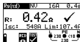
Figura 5.38: Ejemplo de unos resultados de la medición de la resistencia de bucle de defecto usando la función de la protección del disparo
