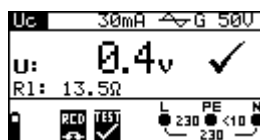
Figura 5.22: Ejemplo de los resultados de la medición de la tensión de contacto
