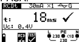
Figura 5.24: Ejemplo de los resultados de una medición de disparo
