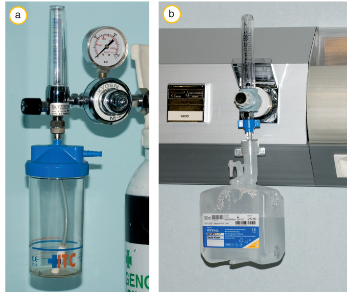
Fig. 8.20. a) Caudalímetro con humidificador y manómetro de presión; b) caudalímetro y humidificador para conectar a oxígeno central (sin manómetro de presión).
