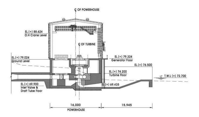
LONGITUDINAL SECTION OF POWERHOUSE
