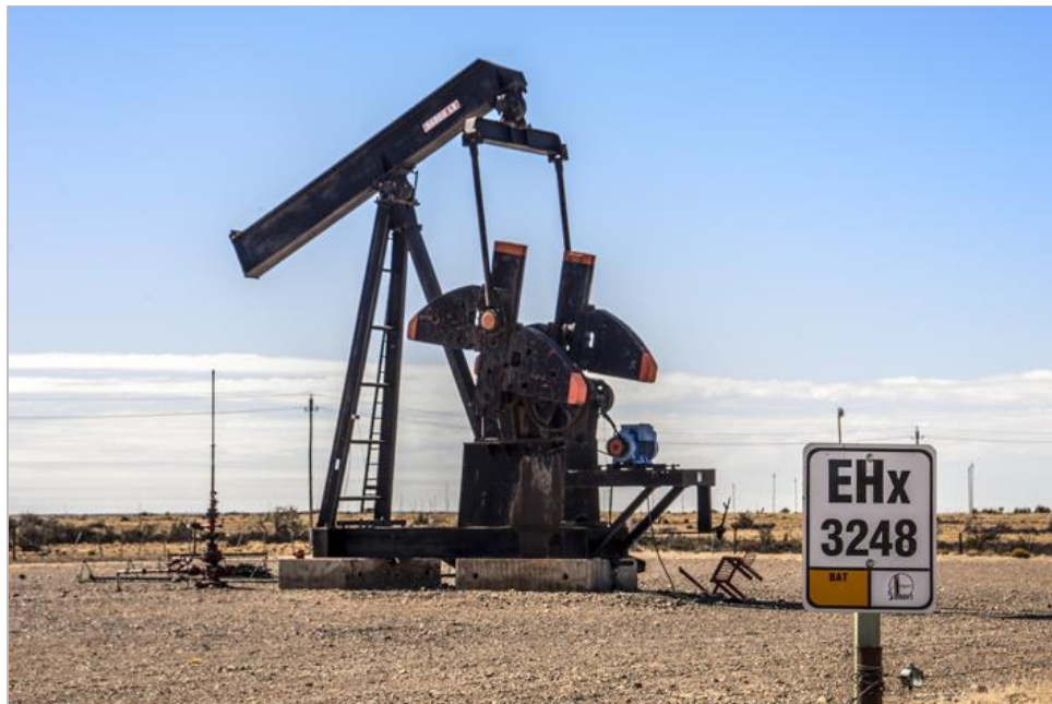
Foto 21. Instalaciones de bombeo del pozo petrolífero EHx-3248 en estado de abandono temporario.
