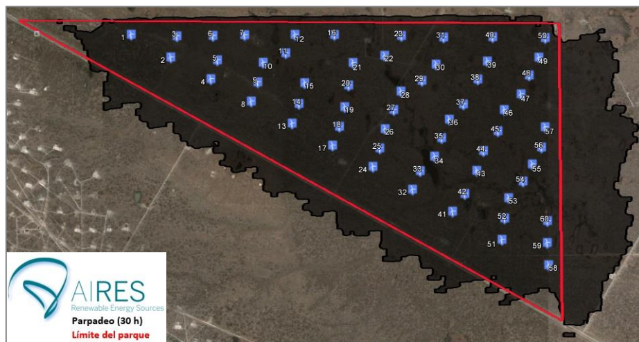
Vista del alcance del “efecto sombra” ( shadow flicker ) de 30 horas anuales del Parque Eólico y el tramo de ruta afectado.
