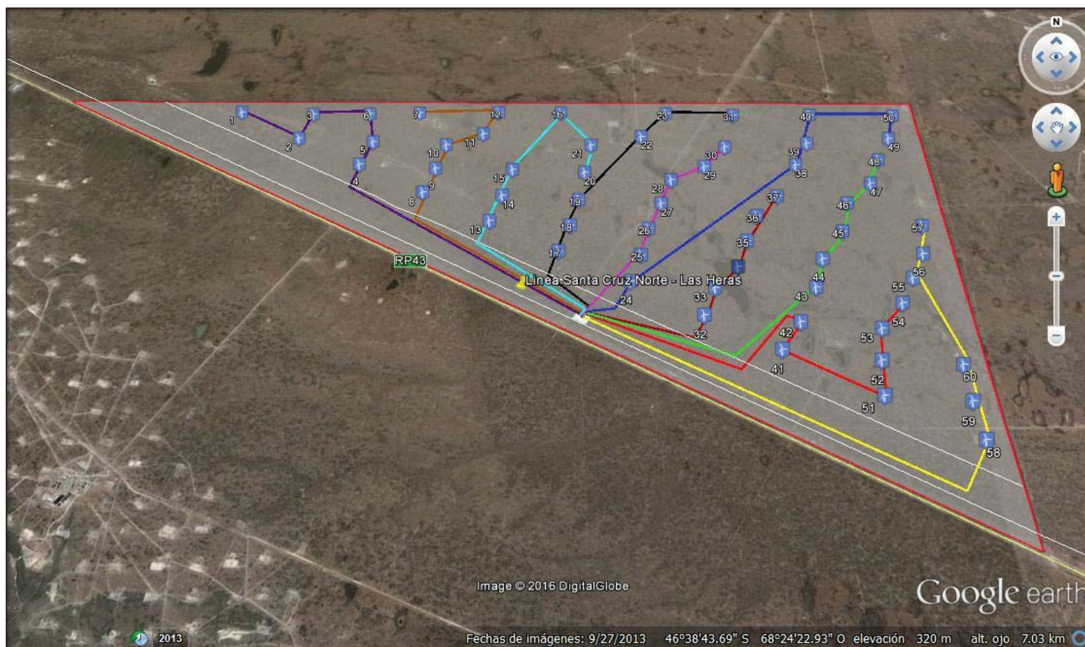
Figura 3: localización de aerogeneradores y circuitos
