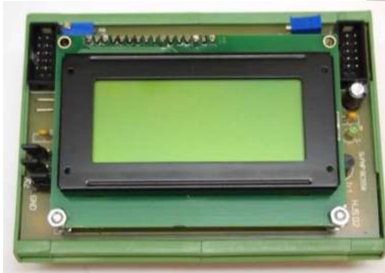
Platine D2 (Display) mit 4 x 16 zur Anzeige im I 2 C Bus
