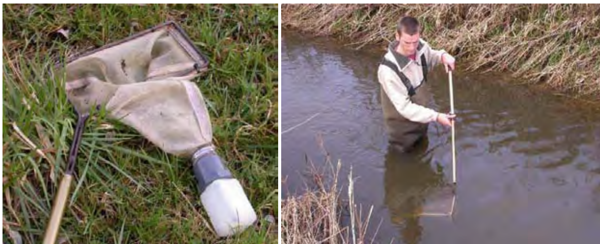
Figuur 5.14: bemonstering van kwabaallarven met behulp van een fijnmazig schepnet. Links: het schepnet zelf; Rechts: wijze waarop de bemonstering werd uitgevoerd.
