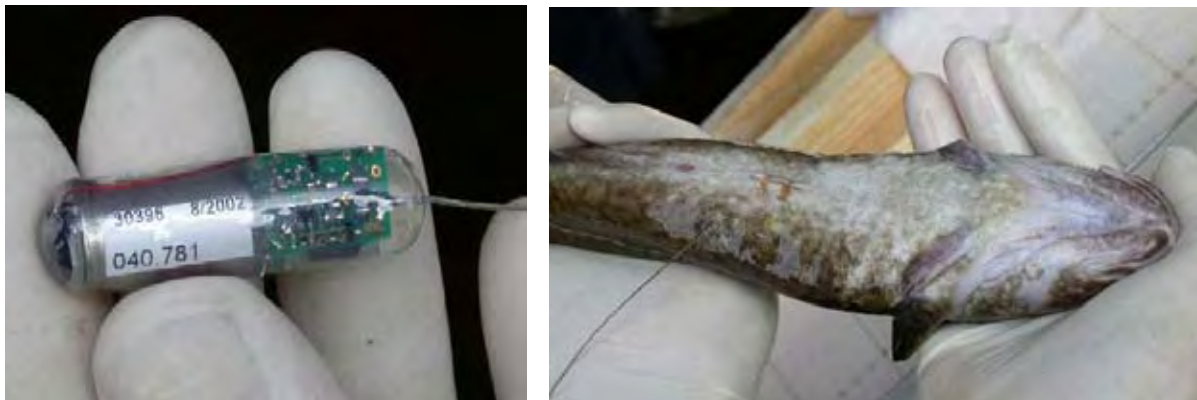
Fig. 5.21: Links: de gebruikte zenders in de periode 2002-2003; op de zender is de serienummer, productiedatum en frequentie af te lezen. Rechts: een kwabaal net na de inplanting van de zender.
