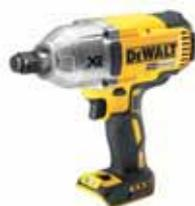
Baugleich mit DCF899P2-QW, aber serienmäßig mit 3/4" Außenvierkant-Aufnahme mit HOG-Ring für sicheren Sitz und schnellen Wechsel der Einsatzwerkzeuge anstelle mit Kugelrastung.
