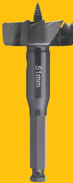
Forstnerbohrer: Für saubere und genaue Bohrungen in Hart- und Weichholz, Holzdielen u.v.m. Durch die Gewinde-Zentrierspitze sind keine Vorschubkräfte erforderlich, da sich der Bohrer selbst ins Material zieht.
