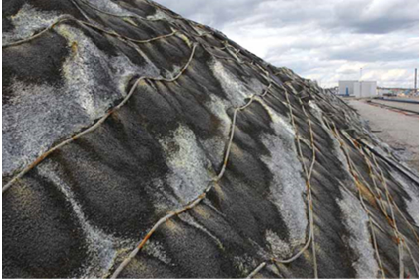
Figure 23 : Lixiviation en tas, mine de nickel en Finlande (Source : www.womp-int.com ).
