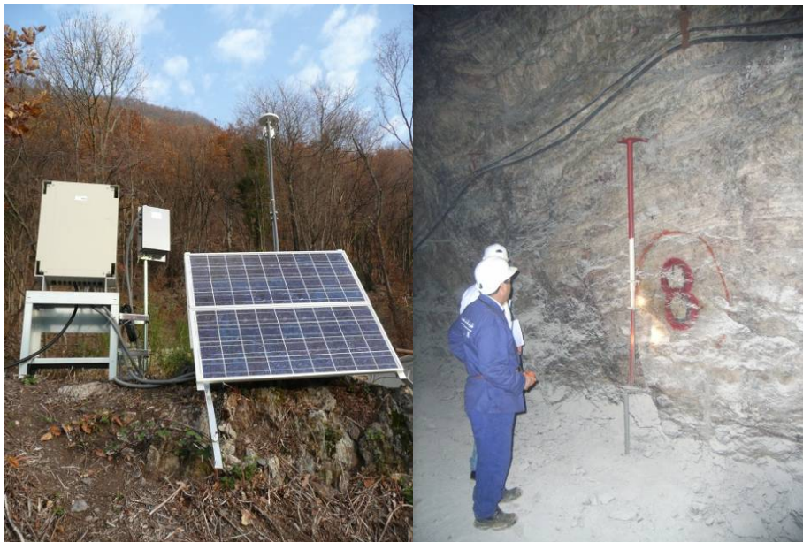
Figure 43. Gauche : Centrale autonome d'acquisition surveillance de surface en Isère (Source : INERIS). Droite : Suivi de la convergence de piliers de sel au Maroc (Source : INERIS).
