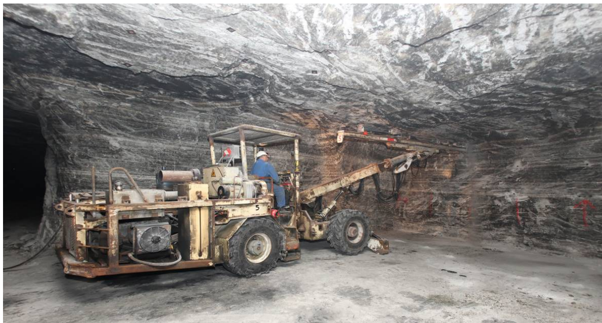
Figure 8 : Foration horizontale dans la mine de sel de Varangéville exploitée en chambres et piliers, en France (Cliché : Comité des Salines de France).
