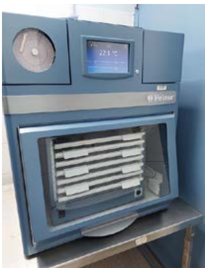
Agitador de plaquetas: equipo en donde se almacenan las plaquetas a temperaturas y condiciones adecuadas.
