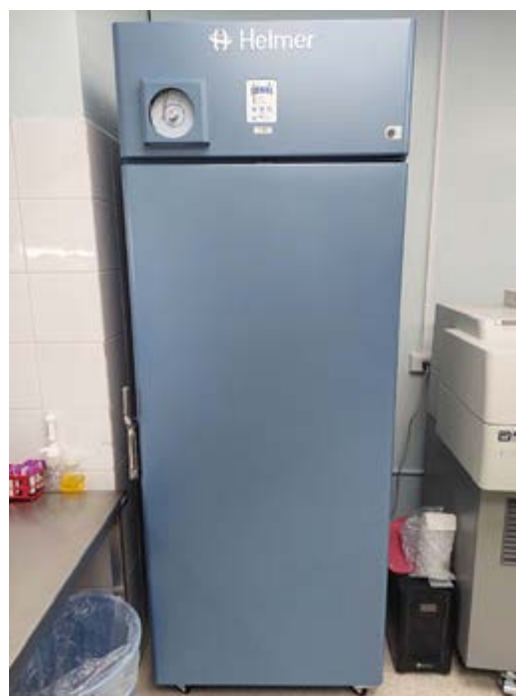
Congelador de Plasma: equipo para la conservación de plasma frescos en temperaturas bajo cero.
