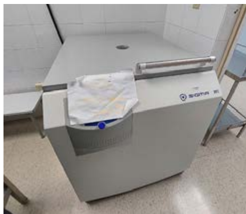
Centrifuga Refrigerada: equipo para el fraccionamiento de los componentes sanguíneos. (Separa los glóbulos rojos, plasma y plaquetas)
