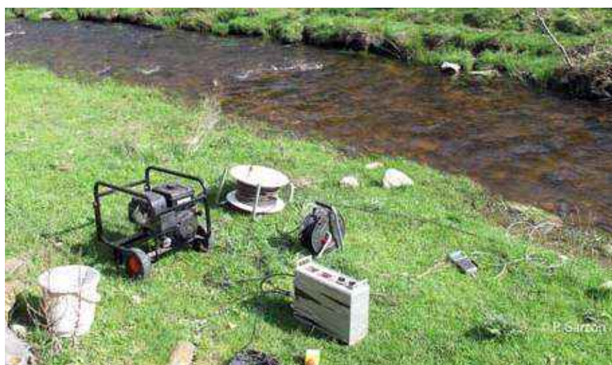
Figura 11. Motor de pesca eléctrica fijo (Erreka). Grupo electrógeno, cable y rectificador
