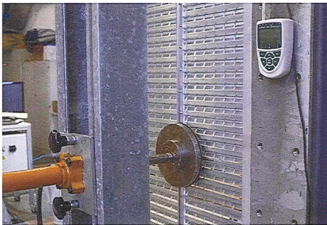
Abb. 3: Prüfaufbau weicher Stoß, Innenseite (Belastungsseite)
