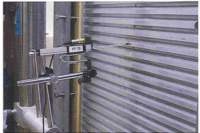
Abb. 4: Prüfaufbau weicher Stoß, Außenseite (Verformungsmessung)
