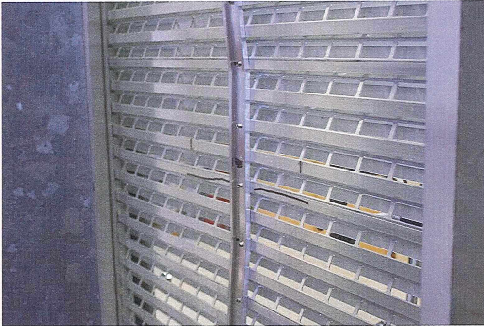
Abb. 6: Prüfkörper 12 (Innen-seite) nach der Entlastung. Das Gitter weist lokal bleibende Verformungen auf, weitere Schädigungen sind nicht zu erkennen.
