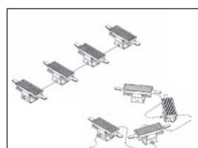
**Mit 50 cm langen Verbindungskabeln entsteht ein Arrangement längs oder im Kreis für entsprechend große Tische.**
