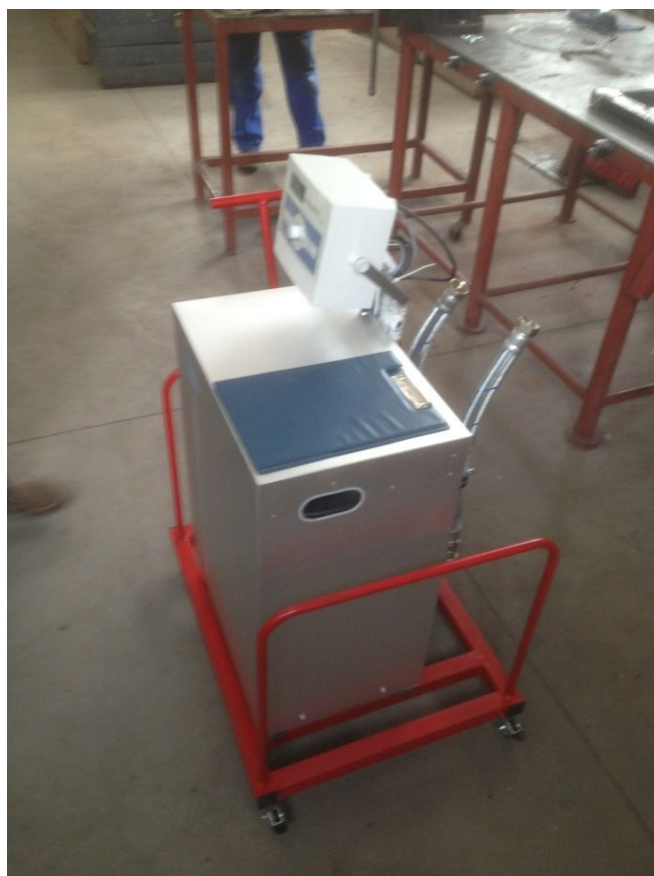
11. ábra VENTO mobil fűtővíz szivattyús vákuumgáztalanító berendezés, (forrás: TA-HYDRONICS [14])
