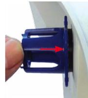
5. Justieren Sie den Filter anhand des Kamera-Livebilds am Monitor: Drehen Sie den Filter mit dem blauen Objektivschlüssel bis zur gewünschten Einstellung nach links (maximal 180°).
