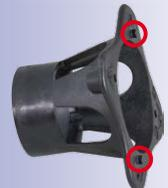
4. **Sensor- bzw. Blindmodul entnehmen:** Setzen Sie den schwarzen **Modulschlüssel** so auf das Sensor- bzw. Blindmodul, dass die beiden Dorne in die entsprechenden Öffnungen greifen (an den Positionen 12 und 6 Uhr). Drehen Sie den Modulschlüssel um 90° nach links bis zum Anschlag.
