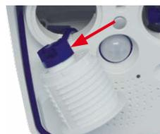
5. **Sensormodul einsetzen:** Achten Sie dabei darauf, dass sich der MOBOTIX-Schriftzug am Sensormodul wie in der Abbildung gezeigt in der „9-Uhr-Stellung“ befindet.
