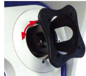
3. Reinigen Sie ggf. die Innenseite des Objektivschutzglases mit einem sauberen, fusselreien Baumwolltuch.
