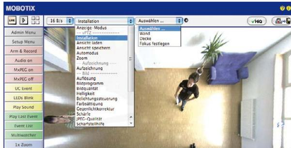
Als Ergebnis erhalten Sie für jeden Bildsensor eine **entzerrte Panorama-Ansicht**, die an die eingestellte Montageart angepasst ist. Die Panorama-Ansicht ist werkseitig voreingestellt und kann wie im Folgenden beschrieben geändert werden.
