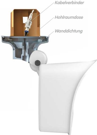
Bei **Aufputzverkabelung** können die an vier Stellen vorgesehenen optionalen Kabeldurchführungen im Fuß des Deckenhalters herausgebrochen werden, um eine saubere Kabelzuführung zur Kamera zu gewährleisten. Das Kamera-Patchkabel muss mit einem entsprechend abgedichteten Adapter mit dem Netzkabel verbunden werden.
