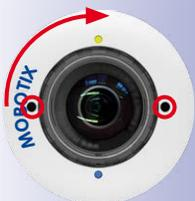
6. **Sensormodul festdrehen:** Drehen Sie das Sensormodul mit dem schwarzen Modulschlüssel nach rechts bis zum Anschlag.
