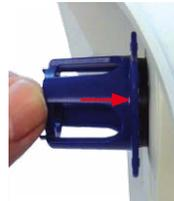
5. Positionieren Sie das Objektivschutzglas mit seinen Bügeln über den beiden Aufnahmen im Sensormodul (rote Pfeile im Bild außen) und drücken Sie es fest ins Sensormodul. Drehen Sie das Glas mit dem blauen Objektivschlüssel bis zum Anschlag **nach rechts**.
