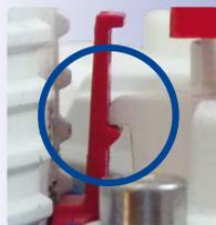
3. **Klappferrit entfernen und Kabel herausziehen:** Entfernen Sie den Klappferrit vom Patchkabel, indem Sie die beiden Halteklammern vorsichtig mit einem kleinen Schraubendreher aufhebeln. Ziehen Sie dann das Patchkabel vorsichtig aus dem Gehäuse heraus (ggf. müssen Sie hierzu den Wandarm demontieren).
