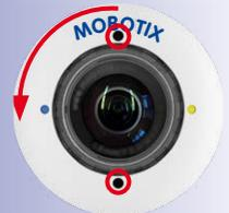
Drücken Sie dann das Sensor- bzw. Blindmodul von hinten aus der Aufnahme.
