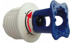
6. Justieren Sie die Bildschärfe anhand des Kamera-Livebilds am Monitor: Drehen Sie hierzu das Objektiv mit dem blauen Modulschlüssel vorsichtig nach rechts oder links. **Schrauben Sie das Objektiv nicht zu weit hinein und wenden Sie auf keinen Fall Gewalt an, um Beschädigungen des Bildsensors zu vermeiden!**
