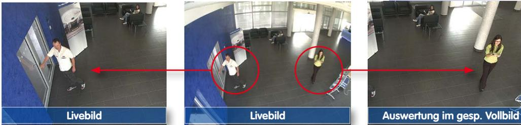
Hier können nun live z. B. in VGA-Auflösung vPTZ-Aktionen durchgeführt werden, während durch die Vollbildspeicherung z. B. mit 1 B/s ein Bild im Format MEGA oder 5MP abgespeichert wird.
