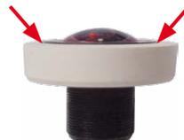
5. Drehen Sie das Objektiv mit Dichtring mithilfe des blauen Modulschlüssels wieder hinein.
