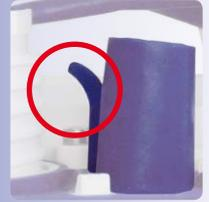
3. Drücken Sie das Frontelement weiter in Richtung Gehäuse und achten Sie darauf, dass das Sensormodul-Kabel weiterhin unter der Haltenase bleibt (roter Kreis in der Abbildung außen).
