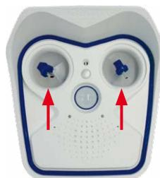
3. **Sensormodul-Kabel einstecken:** Sensormodul-Kabel wie in der Abb. gezeigt fest in die Buchse des Moduls einstecken.
