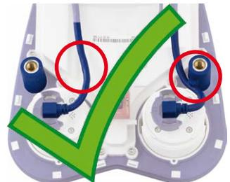
2. Legen Sie die Kamera wie gezeigt auf ihre rechte Seite (in Blickrichtung der Kamera). Drücken Sie das linke Sensormodul-Kabel unter die Haltenase am Schraubdom (roter Kreis in der Abbildung außen).
