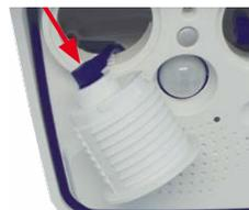
4. **Sensormodul-Kabel verriegeln:** Bajonettverschluss wie gezeigt aufsetzen und im Uhrzeigersinn bis zum Einrastpunkt drehen.
