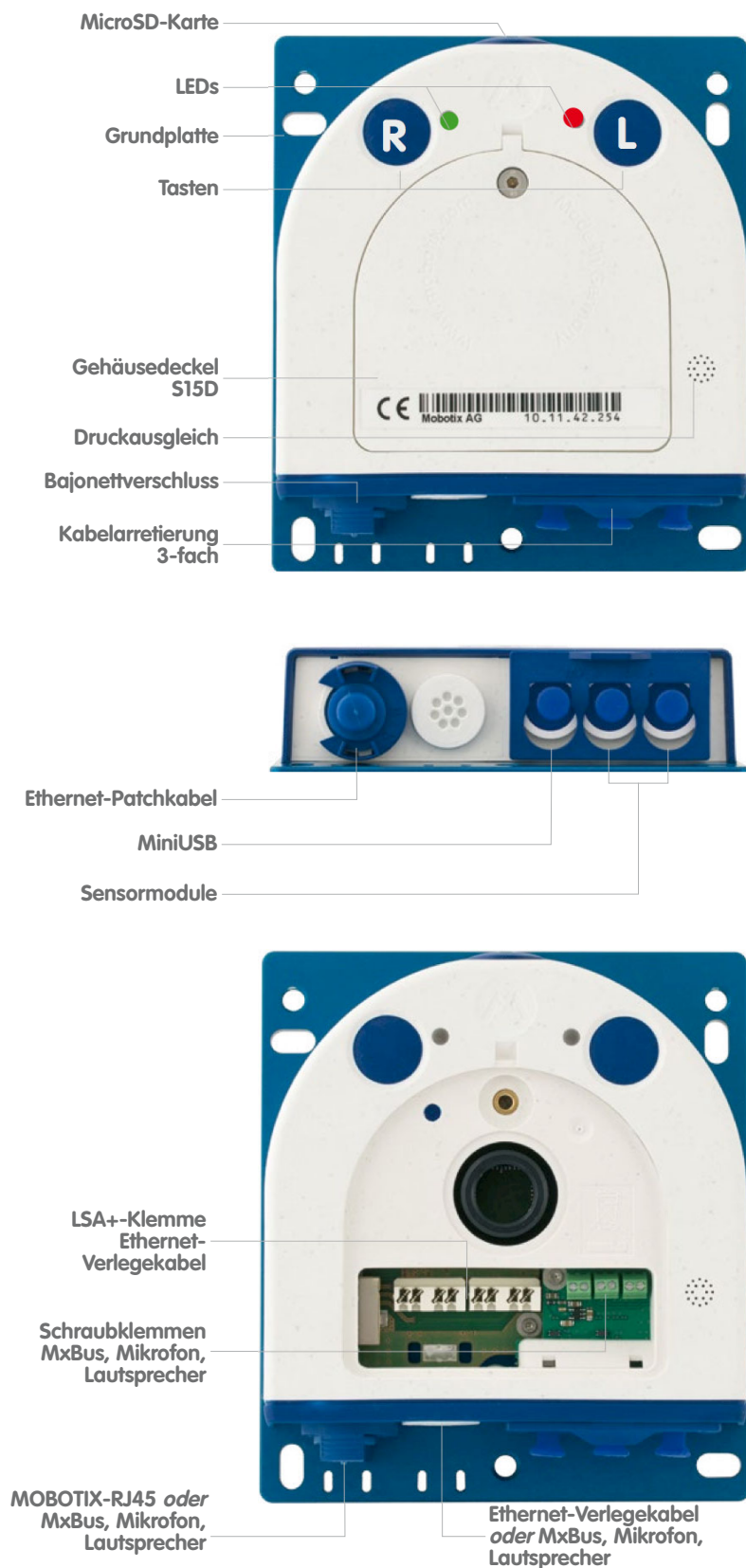
(S15D – Kameragehäuse und Anschlüsse, Auszug aus der technischen Dokumentation)
