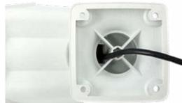
5. **Kabel anschließen:** Das Patchkabel der Kamera via Verbindler anschließen. Darauf achten, dass das Kabel nicht geknickt oder gequetscht wird.
