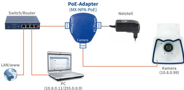
**Verwenden Sie für die M26 das blaue MX-NPA-PoE-Set oder die MX-NPA-Box** – das frühere MOBOTIX Netzwerk-Power-Zubehör NPA-Set, Power-Box und Power-Rack (MX-NPA-Set, MX-NPR-4 und MX-NPR8/20) ist für den Einsatz der M26 nicht geeignet!
