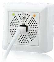
Die **maximale Kabellänge** für die Spannungsversorgung über das Ethernet-Kabel beträgt **100 m**. Zur Reichweitenverlängerung der Ethernetverbindung auf bis zu 500 m kann das als Zubehör erhältliche Mx2wire+ Mediakonverter-Set eingesetzt werden (maximale Übertragungsleistung bei 500 m Leitungslänge: 45 Mbit/s und 12 W für PoE-Gerät).
