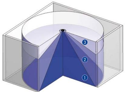
Die **Bildqualität** (Detailgenauigkeit) nimmt mit der Entfernung eines Objekts vom Kamerafokus ab:
