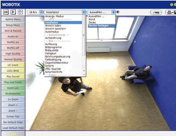
4. Speichern Sie die so eingestellte Nordrichtung permanent, indem Sie erst die Checkbox aktivieren und dann auf Ja klicken.
