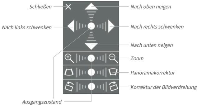
Die Bedienung des OnScreen-Controls erfolgt durch Anklicken der Pfeile im oberen Bereich zum Verschieben des Bildausschnitts. In den unteren Bereichen, die bei Bedarf angezeigt werden, erfolgt die Bedienung durch Klicken rechts und links des Mittelpunktes.
