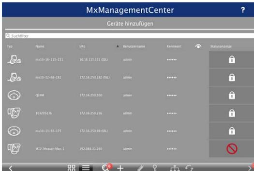
Der Betriebszustand der Kameras wird automatisch getestet und durch verschiedene Symbole angezeigt. So werden z. B. Kameras, die sich nicht in demselben Subnetz wie der Computer befinden, mit dem Symbol (Kamera in einem anderen Netzwerk als der Computer) angezeigt. Diejenigen Kameras, deren Kennwort nicht bekannt ist bzw. für die noch kein
