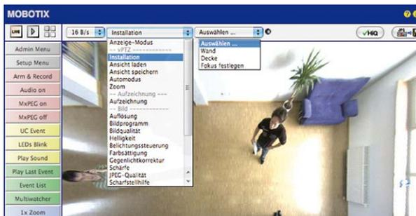
Als Ergebnis erhalten Sie für jeden Bildsensor eine **entzerrte Panorama-Ansicht**, die an die eingestellte Montageart angepasst ist. Die Panorama-Ansicht ist werkseitig vor- eingestellt und kann wie im Folgenden beschrieben geändert werden.
