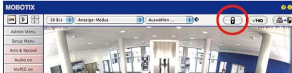
3. Im Kamerabild links oben wird ein neues Icon zur Bearbeitung des Panoramabildes angezeigt. Durch einmal anklicken vergrößern (OnScreen-Control wird angezeigt).
