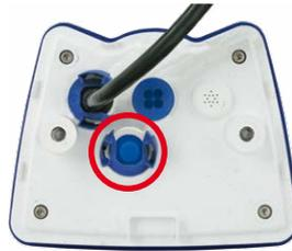
Für die M26 kann kamera-seitig nur ein USB-Kabel mit einem **gewinkelten** MiniUSB-Stecker verwendet werden!
