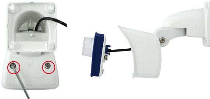
Vor dem Bohren die Kamera vom Gehäuse trennen
