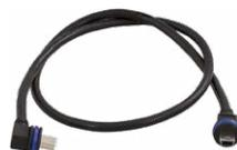
Für die M26 können kameraseitig nur Kabel mit **gewinkelten** Steckern verwendet werden!
