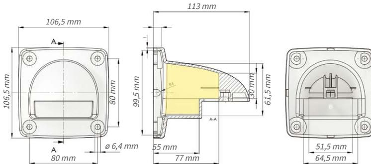
Beim Deckenhalter\* ist die Größe der Kontaktfläche zur Wand/Decke und die Position der Bohrlöcher identisch.
