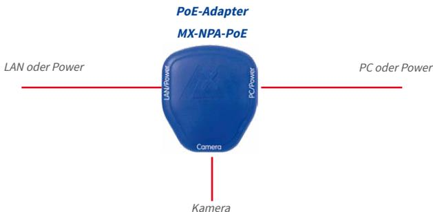
Bei Direktverbindung zum PC ersetzt der PoE-Adapter das Crossover-Kabel
