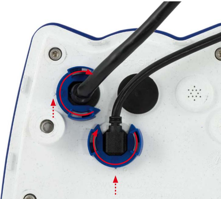
Kabelarretierung schließen durch Drehen des Bajonettverschlusses auf die markierte Position
