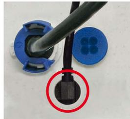
4. **Bajonettverschluss wieder anbringen:** Setzen Sie den Bajonettverschluss wieder auf und drehen Sie ihn im Uhrzeigersinn bis zum Einrastpunkt (siehe Abbildung).
