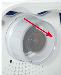
Der weiße Ring in der Objektivkappe verhindert, dass die Kamera-LEDs Reflexionen im Bild erzeugen
