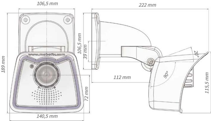
1.4.3 Abmessungen bei Deckenmontage
