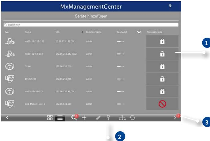
Die Anzahl der ausgewählten Kameras wird im Zähler an der Taste **Nächste Seite** **3** angezeigt. Wechseln Sie zur nächsten Seite und klicken Sie auf **Fertigstellen**.
