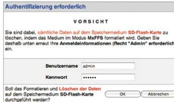
Die Karte wird nun von der MOBOTIX-Kamera formatiert. Für eine 8 GB MicroSD-Karte werden bei deaktivierter Option **Sicheres Löschen – langsam** 5 bis 12 Minuten benötigt. Ist **Sicheres Löschen – langsam** aktiviert, kann dies 3 bis 14 Stunden dauern.
