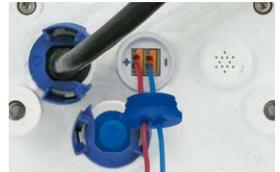
Zum Entnehmen einer Ader entriegeln Sie die entsprechende Seite der Anschlussbuchse, indem Sie mit einem kleinen Schraubendreher auf die orangefarbene Fläche drücken und dann die Ader herausziehen.
