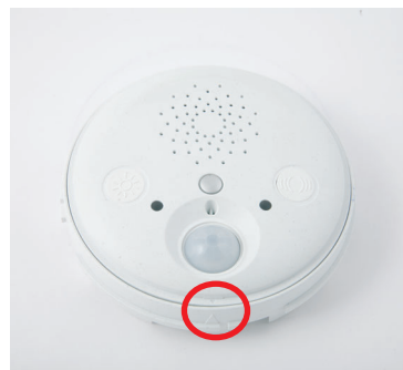
ExtIO-Gehäuse schließen Pfeilmarkierungen ausrichten
