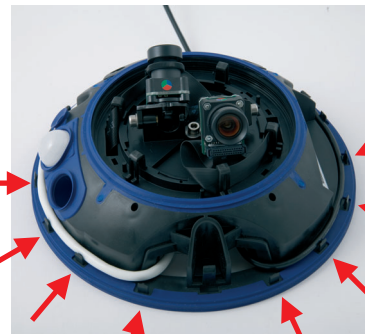
Kabel sorgfältig in den Kabelführungen fixieren
