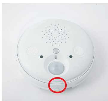
ExtIO-Gehäuse schließen Pfeilmarkierungen ausrichten
