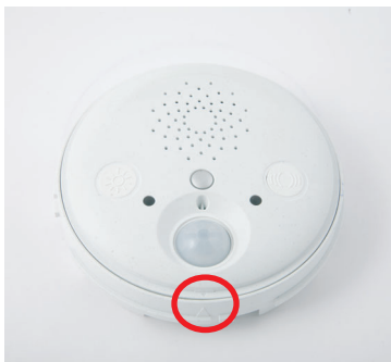
ExtIO-Gehäuse schließen Pfeilmarkierungen ausrichten
