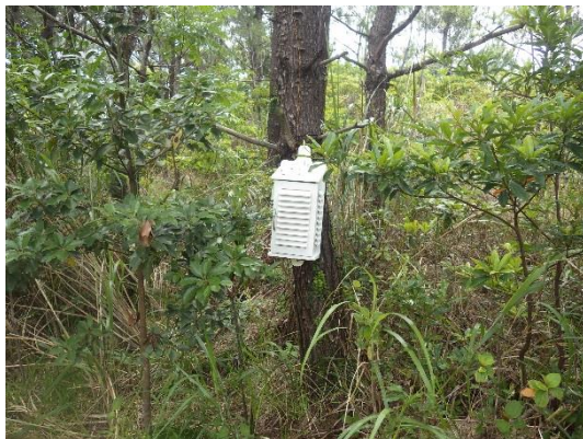
百葉箱内に温湿度センサーを設置
