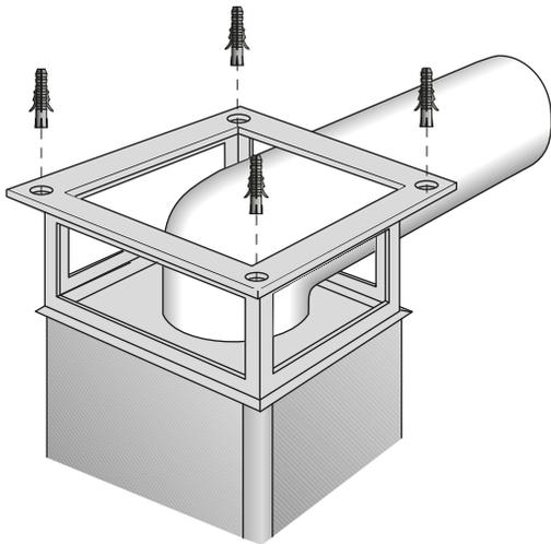
**Deckenadapter** (nicht im Sonderzubehör!) zum Umlenken des senkrechten Luftanschlusses bei Inselhauben durch Abhängen/Überbauen der Haube (Entwurf als Vorschlag zur Eigenfertigung).
