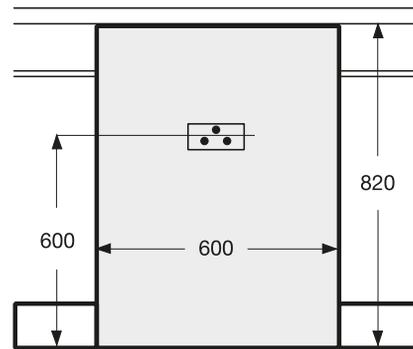
**Elektroanschluss bei Unterschrank**
