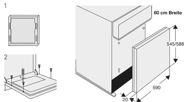
Stufenlose Anpassung an die unterschiedlichen Küchenmöbel-Sockelhöhen durch verstellbare Ausgleichsblendenstücke, die allen integrierbaren Unterbau-Geschirrspülern 60 cm beiliegen.
