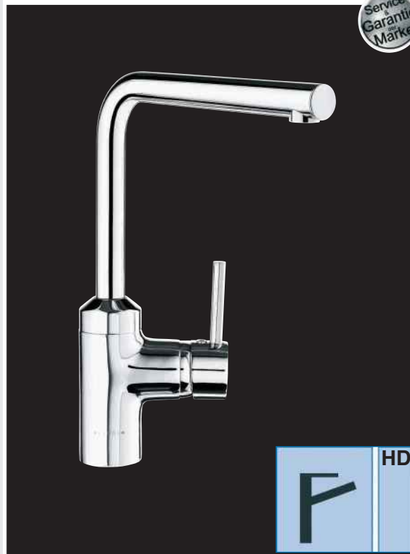
Kludi Line Unterfenster Einhebelmischer in aktuellem Design. Keramikkartusche mit Heisswasserbegrenzer. Verbleibende Sockelhöhe nur 25mm incl. Schläuche.
