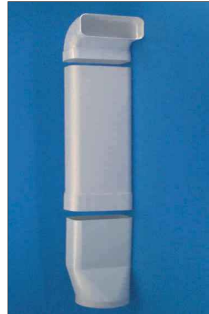
Umlenkset Rundanschluss 150mm (innen 150) über Kanal und Umlenkbogen in waagrechte Flachkanal-Leitung. Mit Muffen. Lufttechnisch günstigere, langgestreckte Form. Breite 235mm. Länge 850mm, kürzbar.
