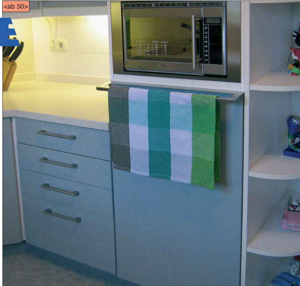
Einsatzbar ab 50er Schubladen/Auszügen/Drehtüren. Mit Aufnahme für Tücher oder Utensilien. Technik, bei welcher Griffe nicht stören. Höhe Aussenseite 16mm, Innenseite 40mm, Tiefe 100mm. Edelstahl gebürstet. Stärke incl. Oberflächenschutz ca. 2,5mm.
