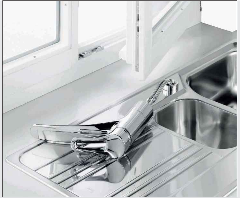
Kludi Line Unterfenster Einhebelmischer in aktuellem Design. Keramikkartusche mit Heisswasserbegrenzer. Verbleibende Sockelhöhe nur 25mm incl. Schläuche.
