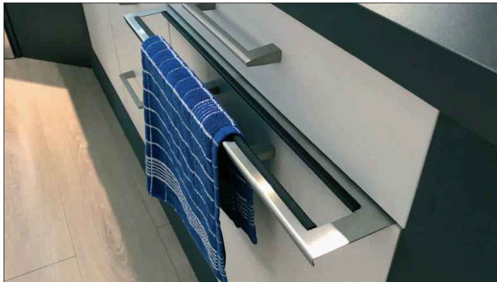
Einsatzbar ab 50er Schubladen/Auszügen/Drehtüren. Mit Aufnahme für Tücher oder Utensilien. Technik, bei welcher Griffe nicht stören. Höhe Aussenseite 16mm, Innenseite 40mm, Tiefe 100mm. Edelstahl gebürstet. Stärke incl. Oberflächenschutz ca. 2,5mm.
