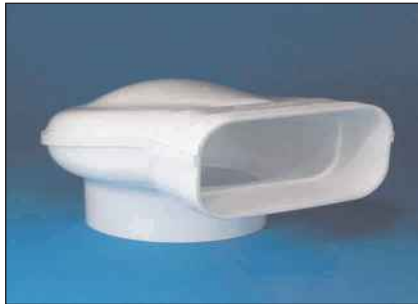
Umlenkstück ProGuide Speziell entwickelte Umlenkung rund auf flach für bessere Luftströmung. Rundanschluss 150mm, mit Muffe zum Einschub von Flachkanal 230 x 80mm. Länge 370mm inkl. Muffe.
