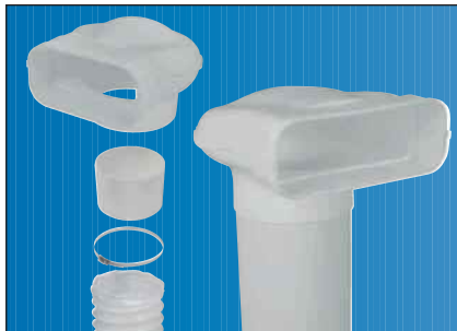
Umlenkstück ProGuide mit Rohr oder Schlauch Rundanschluss 150mm, mit Muffe zum Einschub von Flachkanal 230 x 80mm und Rundrohr oder Flexschlauch Durchmesser 150mm innen sowie 1m lang.
