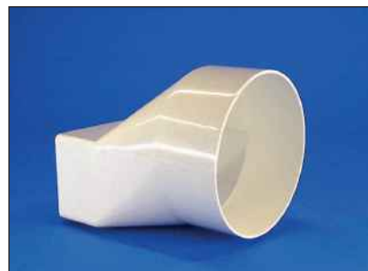
Übergangsstück 100 System 110x54mm weiss mit gerader Auflage und Muffe. Rundanschluss an runder Seite innen 100mm. Mit Muffe.
