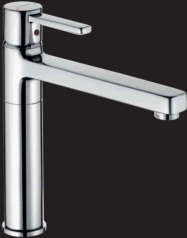
Kludi Zenta - auch in Edelstahl, schwarz und weiss ! Einhebelmischer in hohem, modernem Design. Auslauf, schwenkbar, mit flexiblen Anschlusschläuchen und Keramikkartusche mit Heisswasserbegrenzer.
