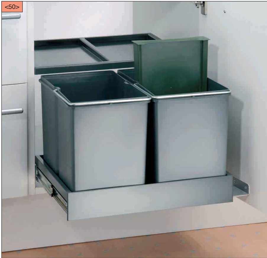
Wesco Automatic-Shorty ab 50er Beim Öffnen der Drehtür fährt das Doppel-Abfalltrennsystem selbsttätig aus dem Schrank heraus. Der Deckel bleibt im Schrank und dient als Ablageboden. Für alle Drehtürenschränke ab 50cm. Universell links und rechts montierbar. Profi-Optik. Vollauszug 2 x 15 Liter. Tür-Öffnungswinkel 110°.
