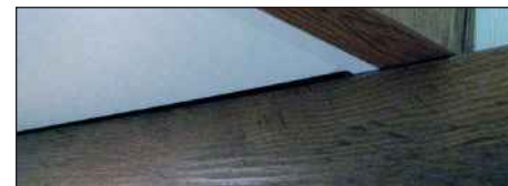
Schon ein kleiner Schlitz von min. 8mm zwischen Nischenwand und Schrankboden reicht aus um die Klemmvorrichtung einzuführen und die Leuchte zu montieren.
