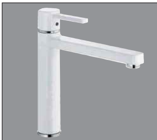
Kludi Zenta - auch in Edelstahl, schwarz und weiss ! Einhebelmischer in hohem, modernem Design. Auslauf, schwenkbar, mit flexiblen Anschlusschläuchen und Keramikkartusche mit Heisswasserbegrenzer.
