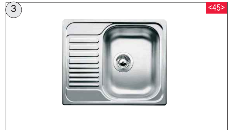
BlancoTipo 45 S Mini 605 x 500mm, reversibel, Siebkorbventil mit Ab-/Überlaufgarnitur. Ab 45er Schrank. Ausschnitt: 587 x 482mm.
