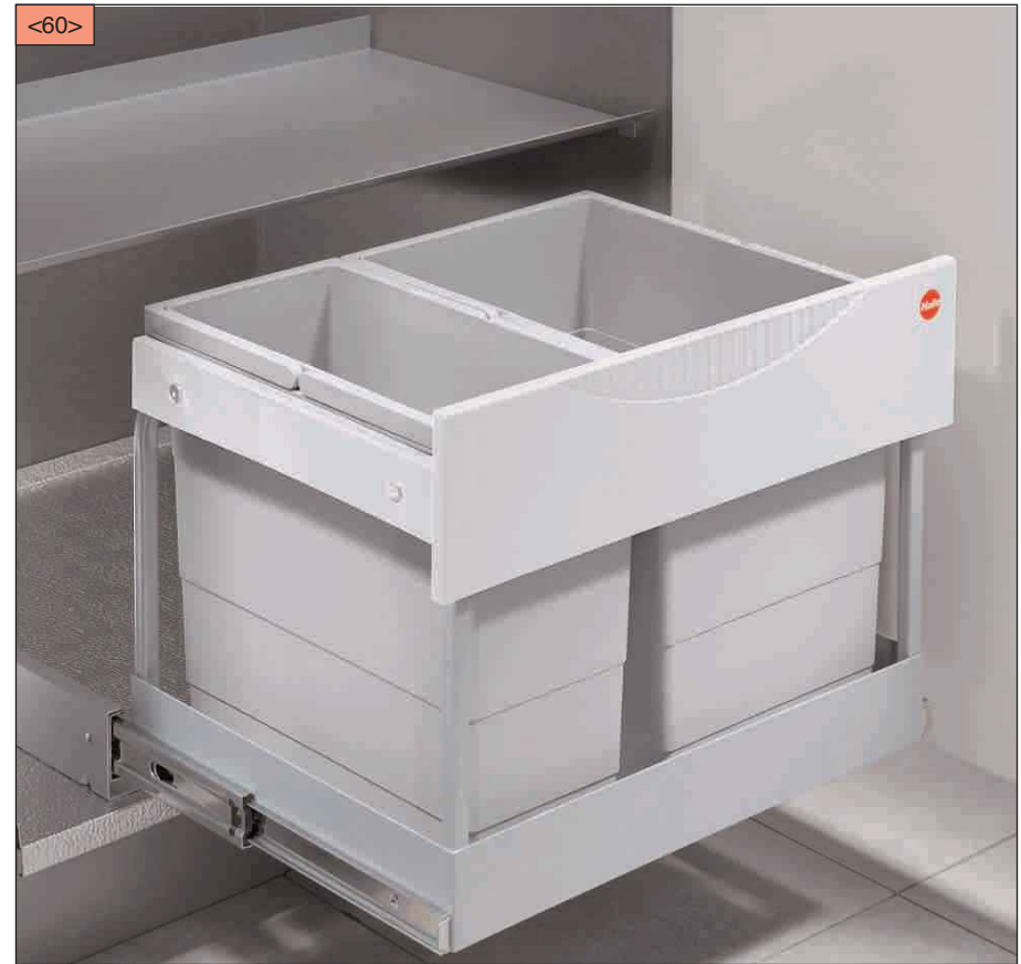
Hailo Raumspar-Tandem ab 60er Kompakte Bauweise - flach und kurz. Einfache Bodenmontage des Abfallsammlers mit zweifach- oder dreifach-Trennung. Kugelgeführter Vollauszug. Für Drehtürenschränke ab 60cm.
