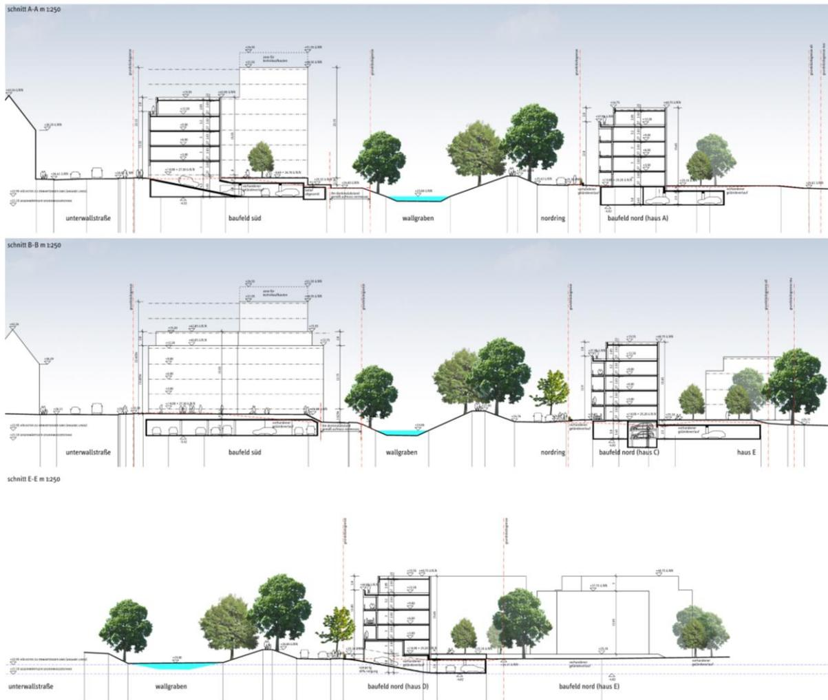
Abbildung 9: Systemschnitte städtebauliches Konzept mit Schnitt durch die Tiefgarage, Stand November 2023, Quelle: Konrath und Wennemar Architekten
