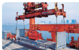
フラット・ラック・コンテナ 長尺物、重量物、またはコンテナ詰めできない大型貨物を輸送する
