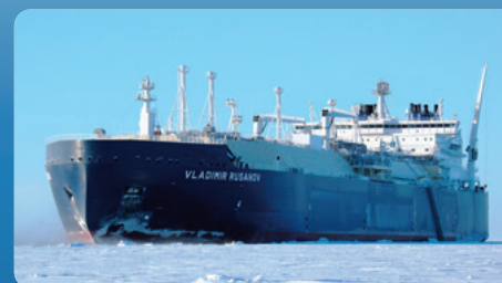
砕氷LNG船。タンク容量は、172,000m 3
