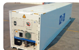
冷凍コンテナ (リーファー・コンテナ) 冷凍ユニットを内蔵し、所定温度を保持する
