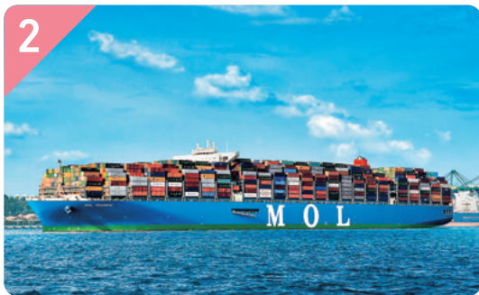
20,000TEU型コンテナ船。全長400m、全幅58.8m ※現在の船名および船体は上記画像とは異なります
