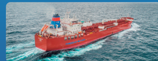
船体にPOWERED BY METHANOLと表した、メタノールと重油の2元燃料に対応可能なメタノールタンカー
