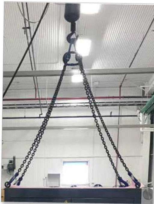
图 3-11 将吊索连接到所有四个吊环螺栓上
