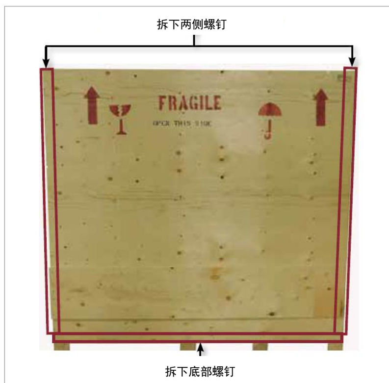
图 3-8 拆下木箱两侧和底部的螺钉
