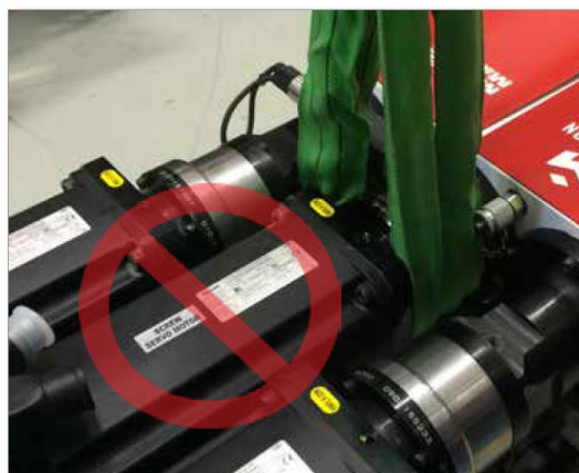
图 3-12 不要将电机用作起吊点。
