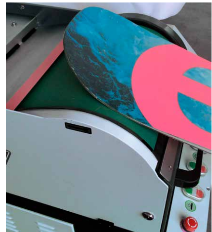
LAVORAZIONE SUL RULLO DI CONTATTO PARTICULAR: WORKS ON CONTACT WHEEL
